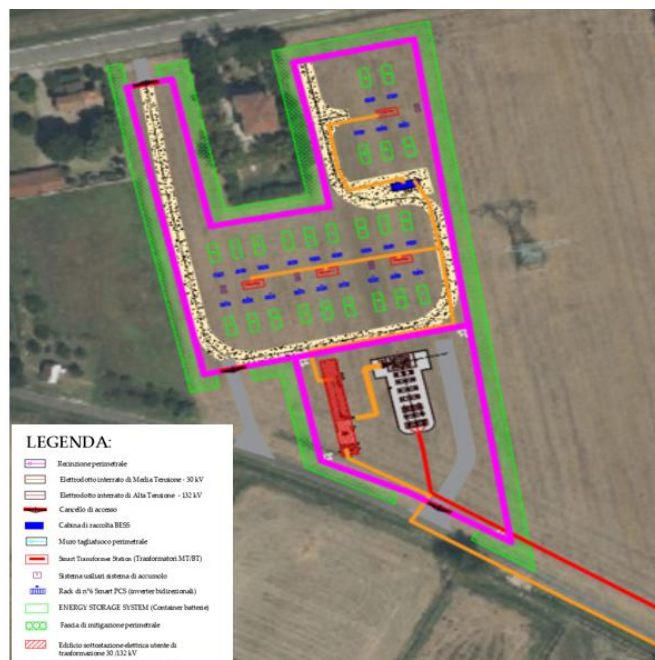
Figura 9: Sistema di accumulo e Sottostazione elettrica utente
