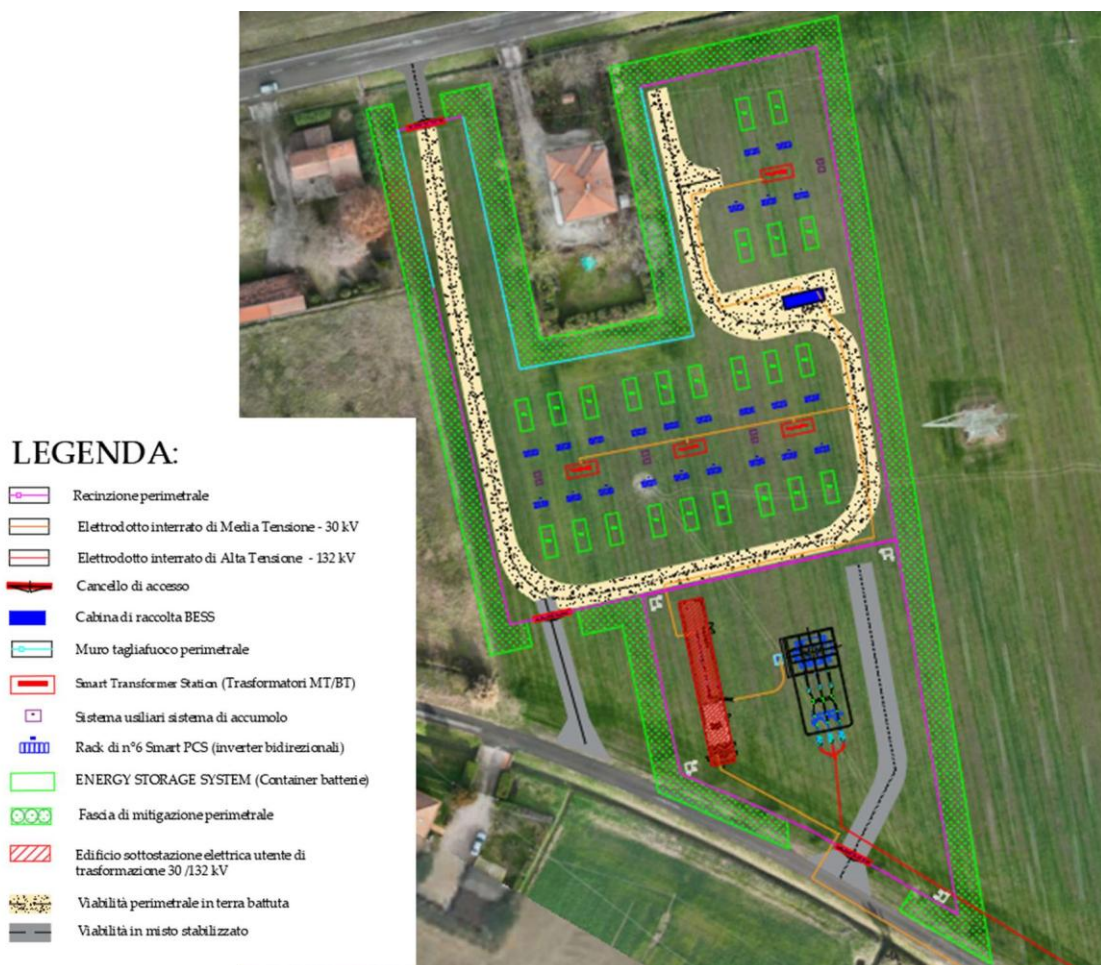
Figura 10: Planimetria Ortofoto del sistema BESS e della Sottostazione elettrica utente 30/132 kV
