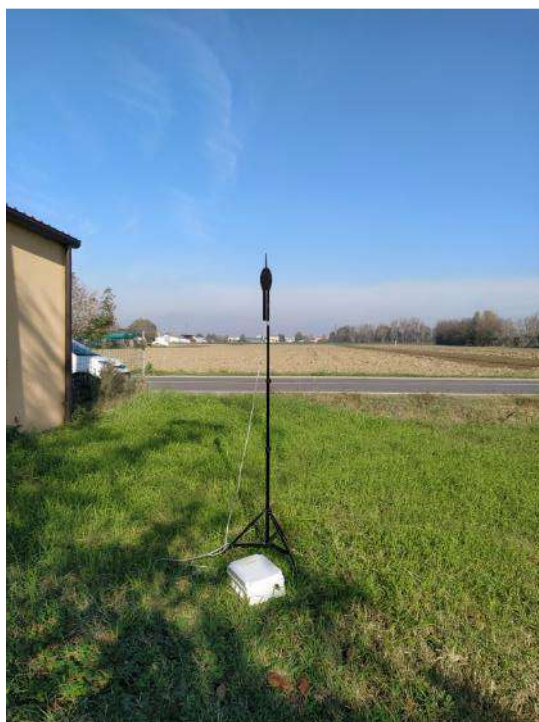
Figura 3 - Esempio posizionamento fonometro RUM_01 e RUM_02
