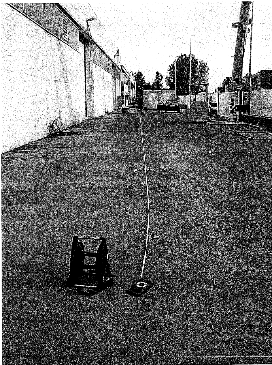
Stendimento sismico onde di superficie MASW
