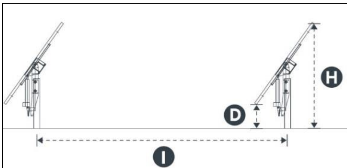
Figura 46 - Disposizione tipo dei tracker
