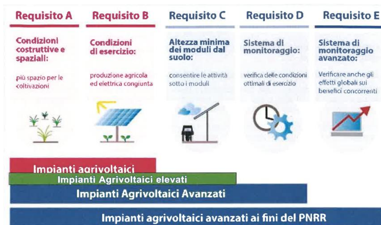
Figura 3-1: Requisiti degli impianti agrivoltaici: elaborazione dalle Linee Guida MiTE
