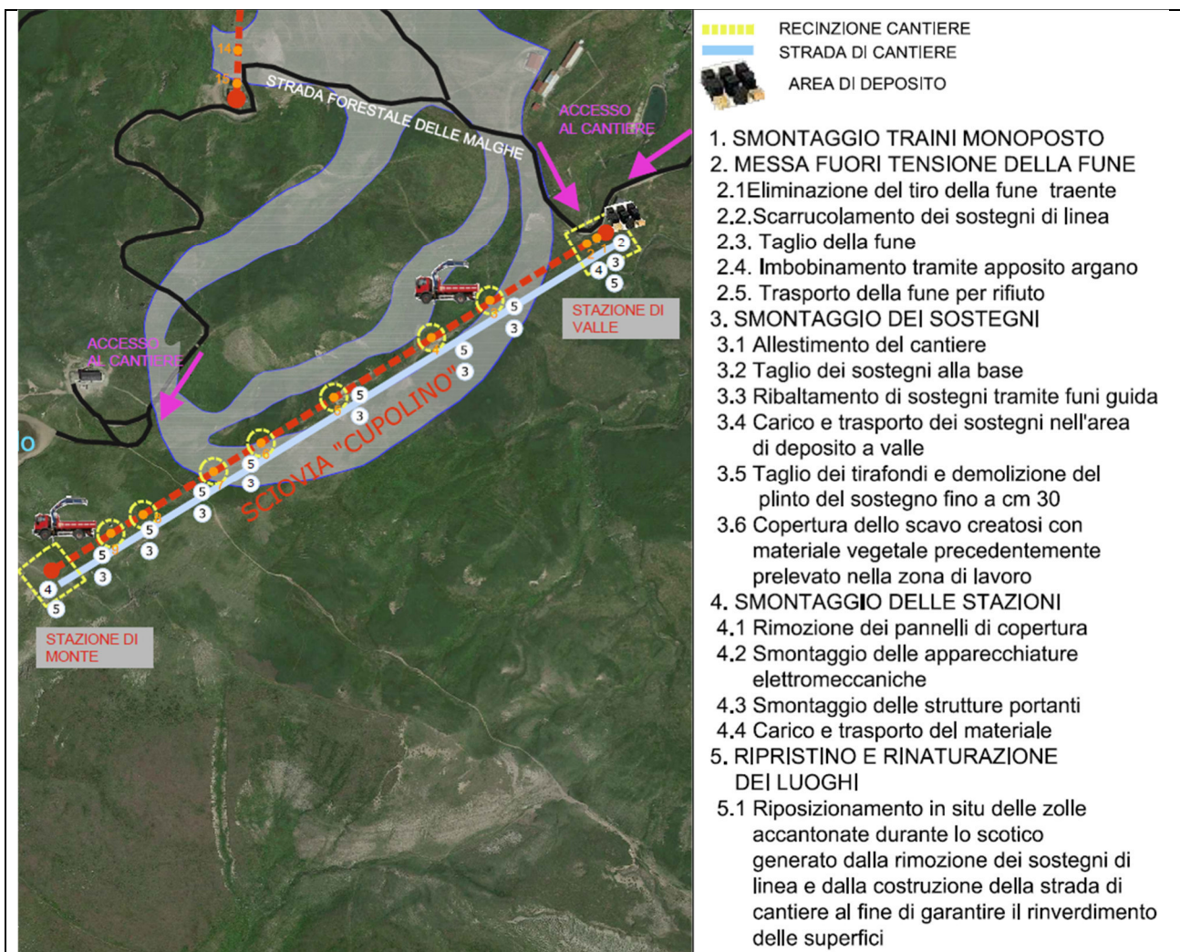
Figura 32 Cantierizzazione smontaggio sciovia “Cupolino”
