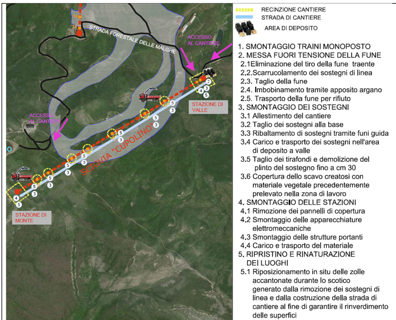
Figura 7 Cantierizzazione smontaggio sciovia “Cupolino”
