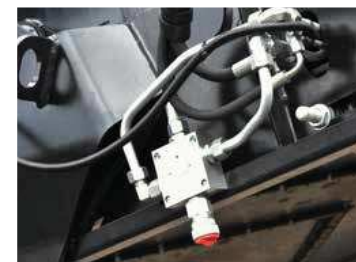
Regolazione velocità nastri trasportatori
