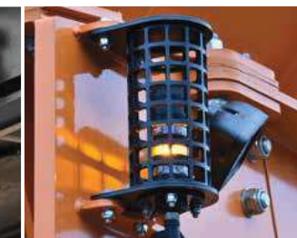
Indicatore stato operativo – per controlli dello stato e allarmi di sicurezza
