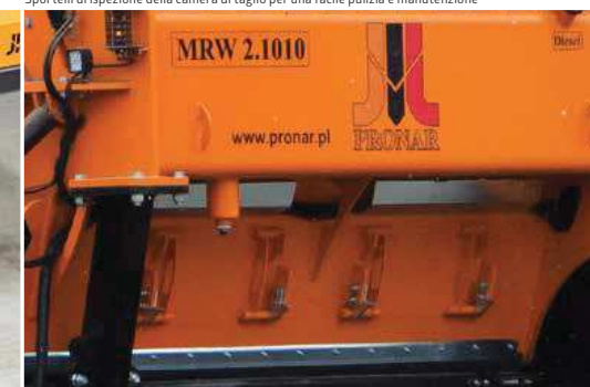
Sportelli di ispezione della camera di taglio per una facile pulizia e manutenzione
