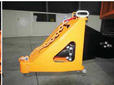
Dispositivo di collegamento per l'occhiello di traino per lo spostamento del trituratore con veicoli da costruzione
