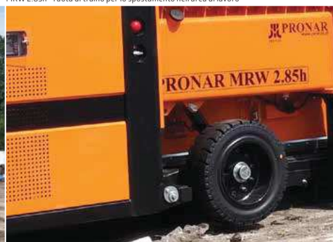
MRW 2.85h - ruota di traino per lo spostamento nell'area di lavoro
