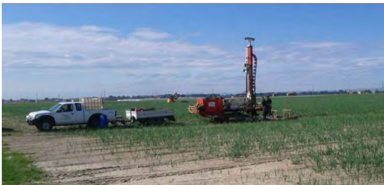
Fig.9. Sonda Tecnotunell TS80 utilizzata per i sondaggi geognostici
