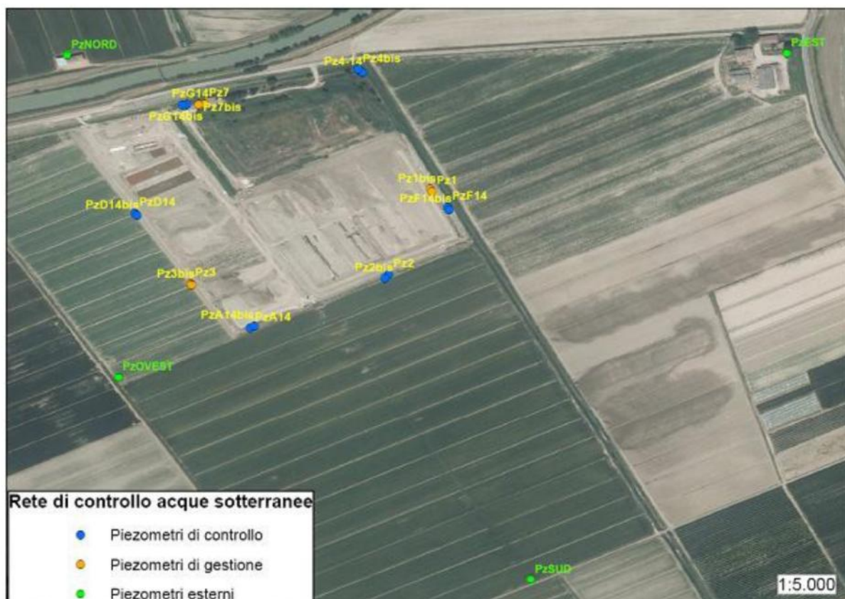
Figura 7 – Piezometri di monitoraggio della discarica e di controllo delle aree esterne (in verde)
