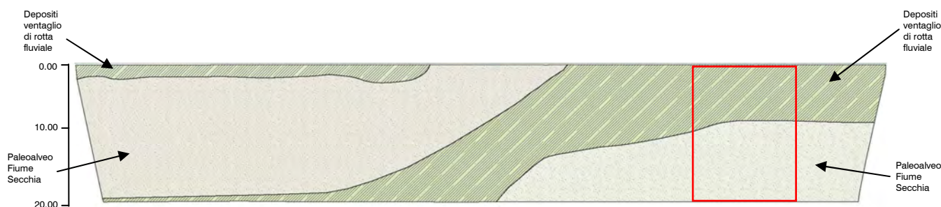
Fig. 6.2: Ipotesi distribuzione paleoalvei e depositi di ventaglio di rotta fluviale.
