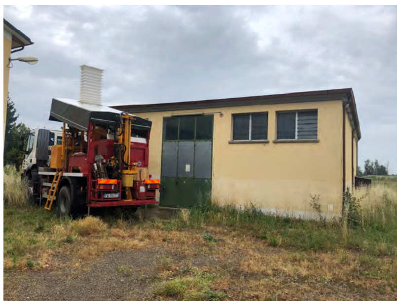
Fig. 5: Penetrometro utilizzato per eseguire le prove penetrometriche nell'area di interesse.
