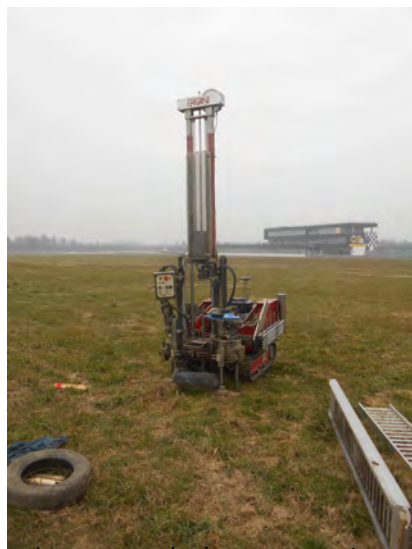
Fig. 5.2: Penetrometro utilizzato per eseguire le prove penetrometriche nell'area di interesse.
