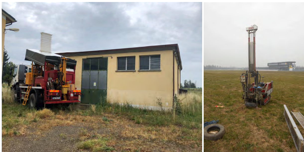
Fig. 5.2: Penetrometro utilizzato per eseguire le prove penetrometriche nell'area di interesse.
