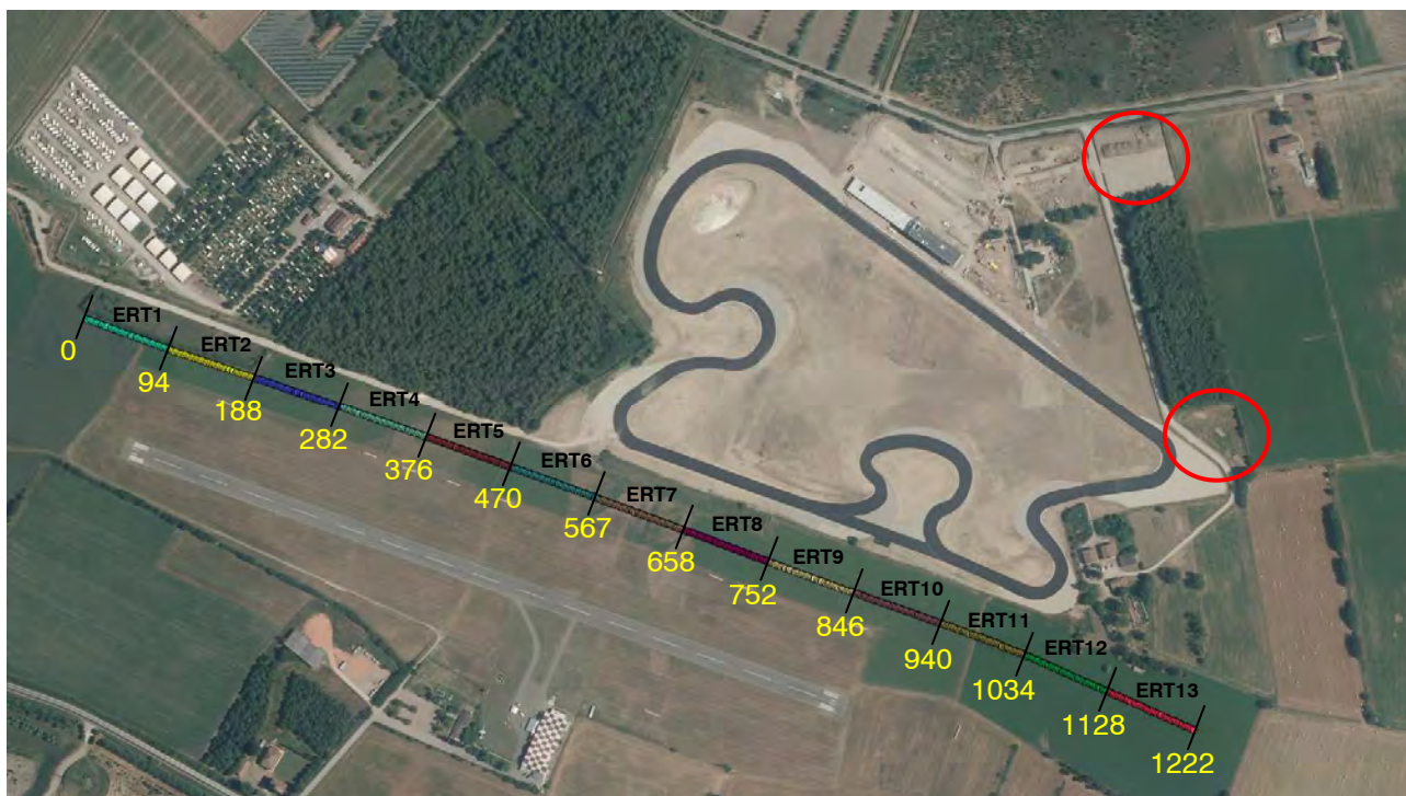
Fig. 6.7: Ubicazione della linea tomografica eseguita.
