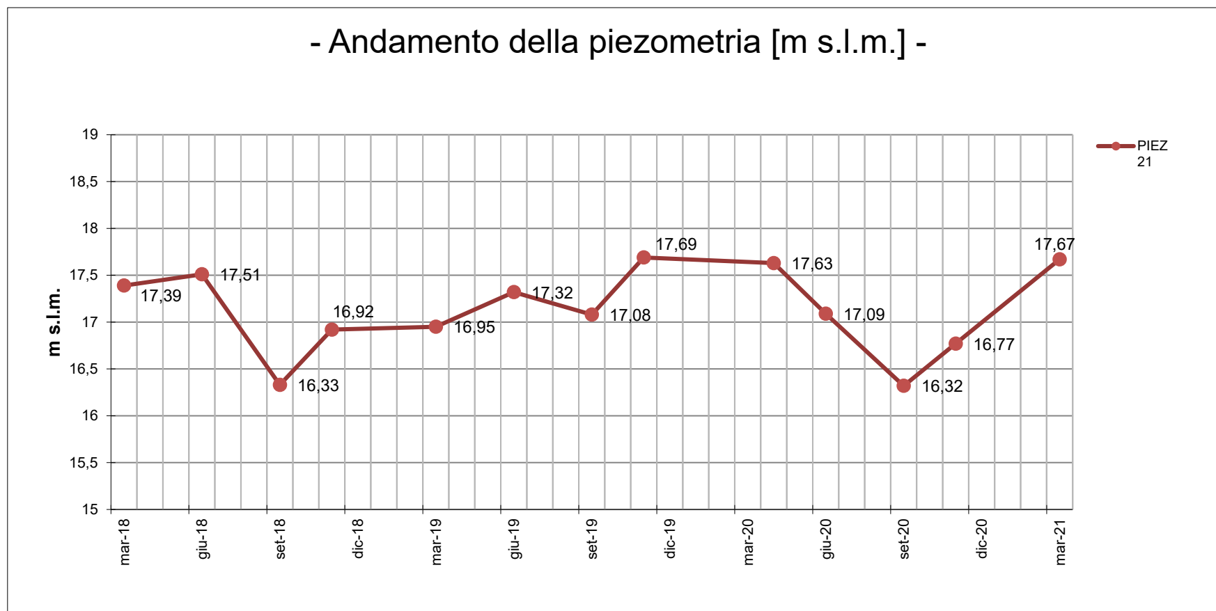
Fig. 2.3 – Andamento del livello piezometrico (m s.l.m.) della falda superficiale rinvenuto in corrispondenza del piezometro PZ21 nel periodo di monitoraggio Marzo 2016-Marzo 2021.
