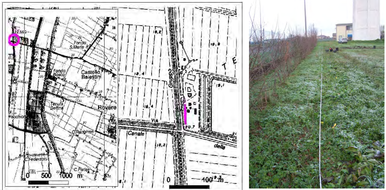
Figura 1. A sinistra: Estratto da CTR con ubicazione dello stendimento MASW. A destra: stendimento sismico MASW (base della torre piezometrica in alto a destra nella foto).
