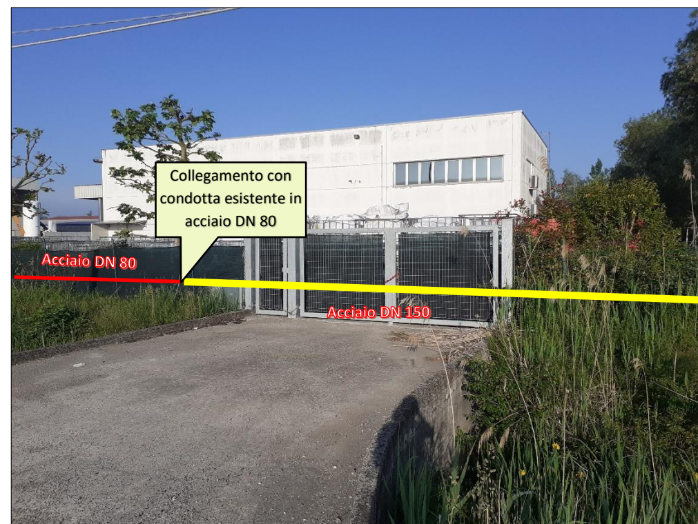
Fotografia 1: Collegamento con condotta esistente all'interno della Proprietà Tred Carpi
