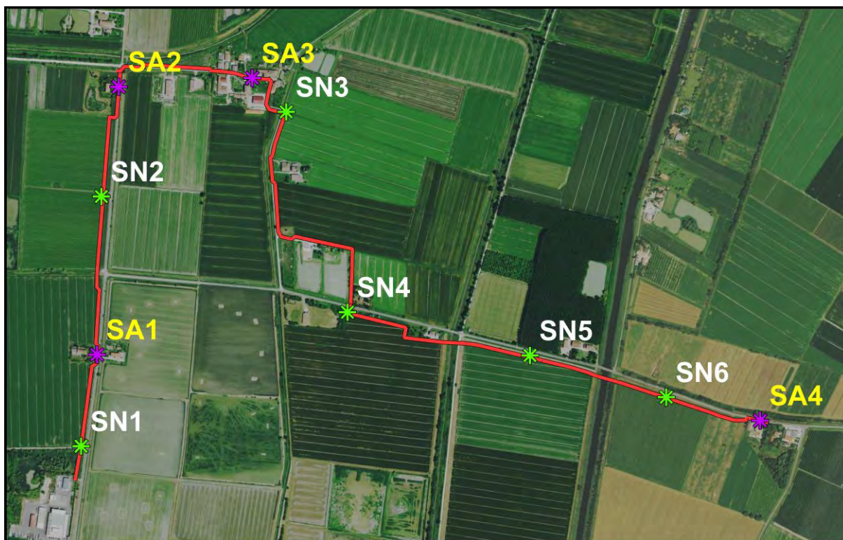
Fig. n. 1 – inquadramento generale condotta con ubicazione sondaggi con escavatore (SN= in terreno naturale; SA= in area stradale)
