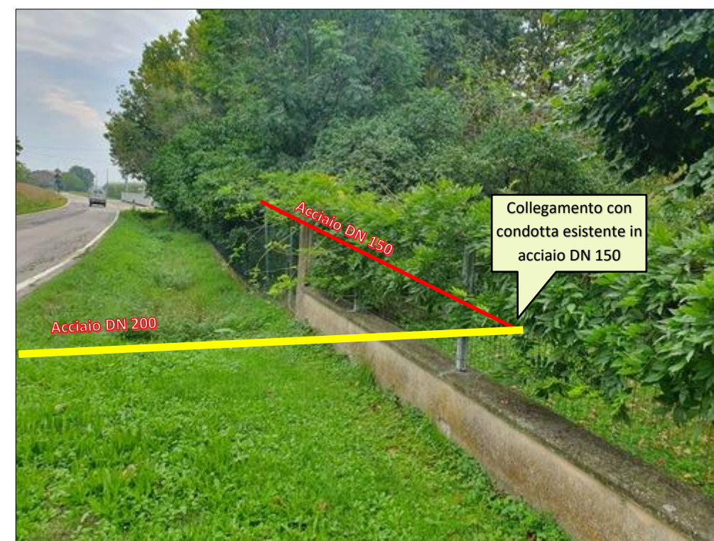
Fotografia 75: Collegamento condotta esistente – Attraversamento fosso Via 25 Aprile
