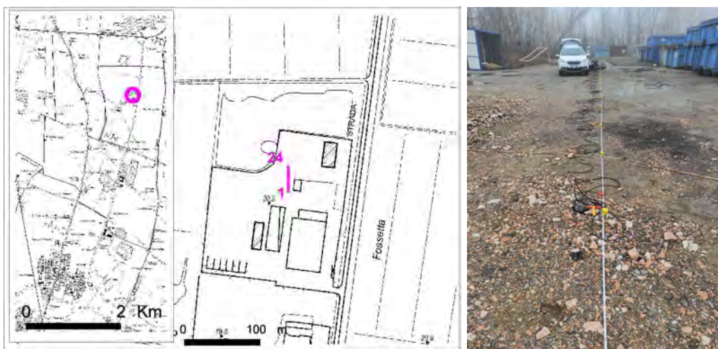
Figura 1. A sinistra: Estratto da CTR con ubicazione dello stendimento MASW (con indicazione della posizione dei geofoni 1 e 24) e inquadramento territoriale; a destra: stendimento sismico MASW eseguito a Carpi (MO), in località "Fossoli", Via Remesina Esterna, 27/A, fotografato dall'estremità indicata con 1 nella carta.
