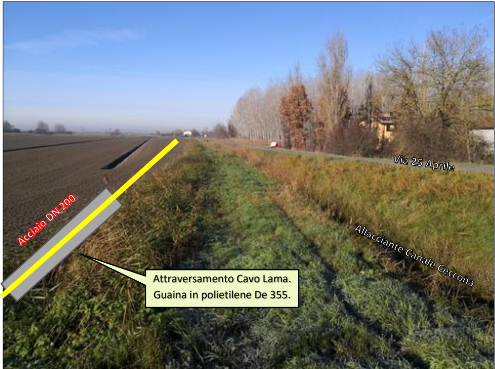
Fotografia 63: Tracciato condotta su terreno naturale e attraversamento Allacciante Canale Ceccona
