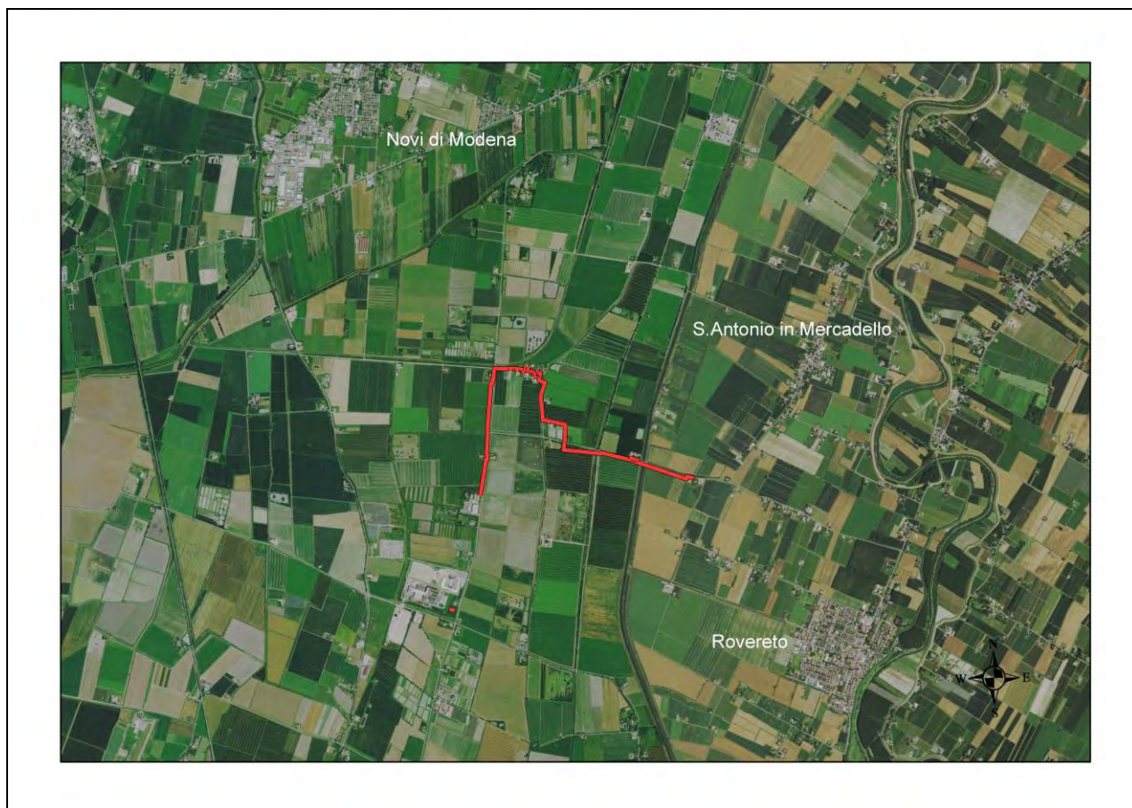
Fig. 1 - Inquadramento territoriale (non in scala); la spezzata in rosso indica il tracciato della condotta in progetto.
