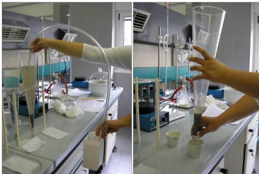
Figura 4-5: Recupero del surnatante (a sinistra) e della frazione sedimentata (a destra).
