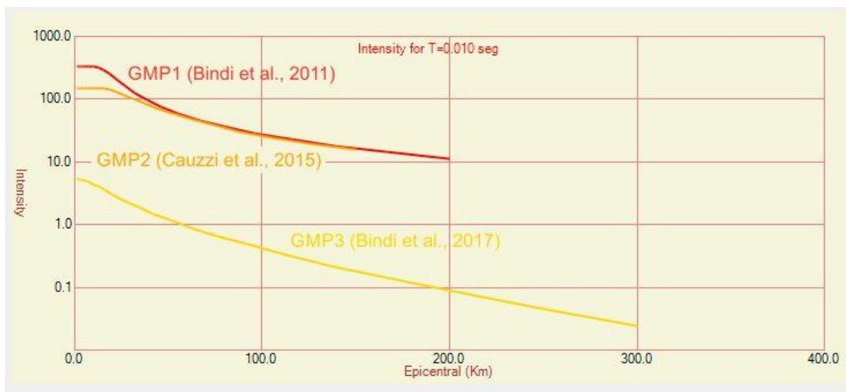
Figura 11 Grafico “intensità - distanza epicentrale” per le tre relazioni di attenuazione utilizzate nella simulazione.
