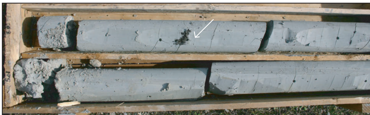
Fig. 2 Dettaglio del sondaggio 3, bacino 4, metri -5/-7. Risulta visibile un frammento di legno nella parte superiore della carota.
