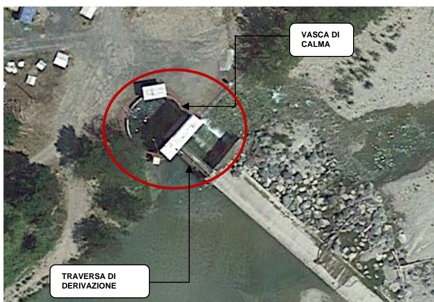
FIGURA 5-2: PARTICOLARE DEL MANUFATTO DI DERIVAZIONE E DELLA VASCA DI CALMA
