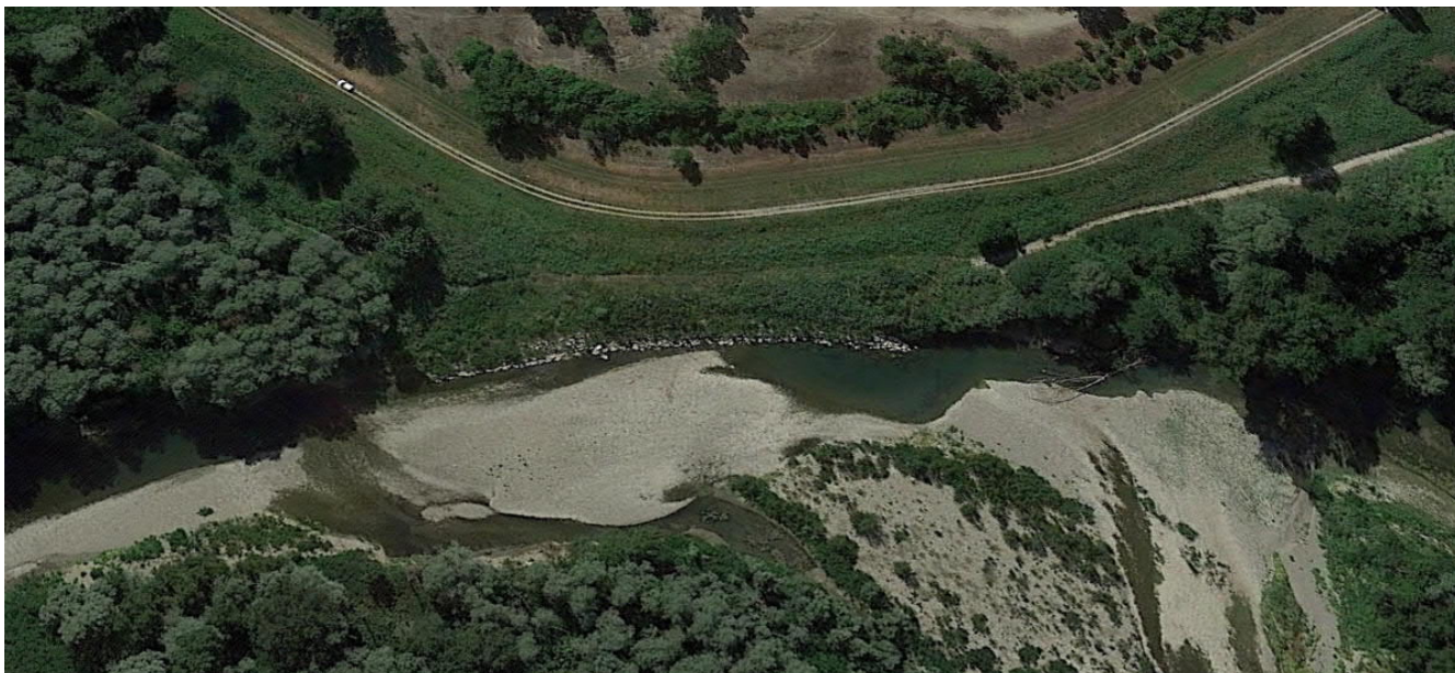
Foto 1 – Vista aerea (da Google Earth) dell’erosione della sponda destra del fiume Secchia in un tratto in cui l’argine della cassa d’espansione è praticamente in froldo
