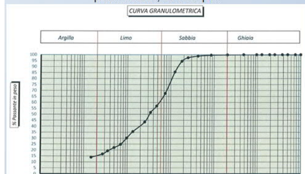
Fig. 38 – Prove granulometriche effettuate su campioni prelevati all'interno della cassa in linea
