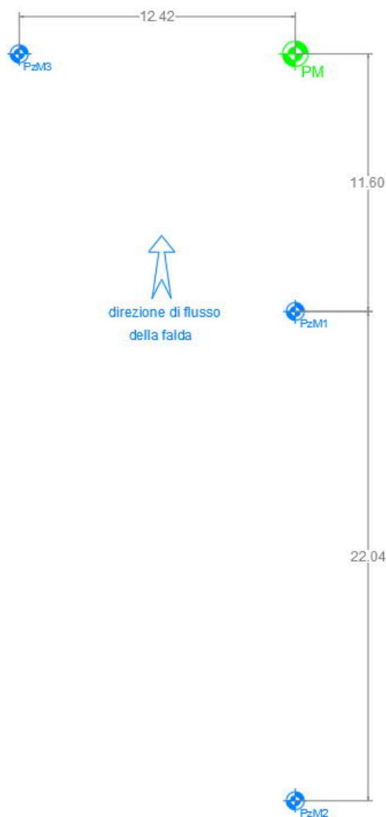
Fig. 19 – Schema di disposizione dei pozzi per la prova di monte
