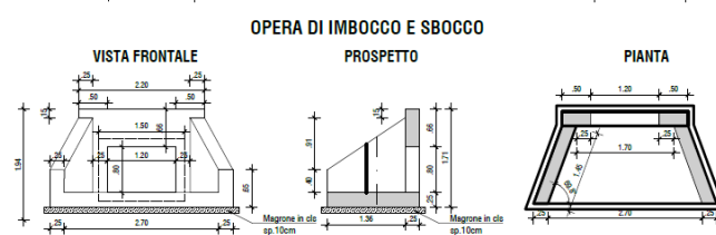
TIPOLOGICO TOMBINO SECONDARIO - NR°1 TUBAZIONE DN600 SCALA 1:50
