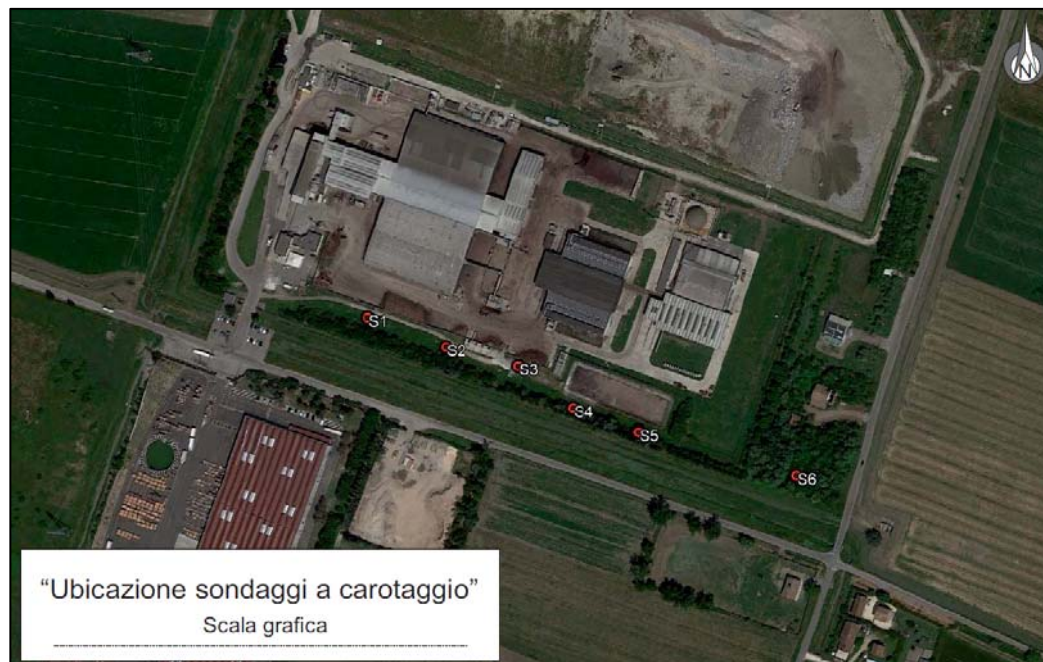
Fig. n. 2.6.2 – Ubicazione dei sondaggi a carotaggio continuo eseguiti in data 02/11/2021 presso l'area oggetto di produzione delle terre e rocce da scavo.
