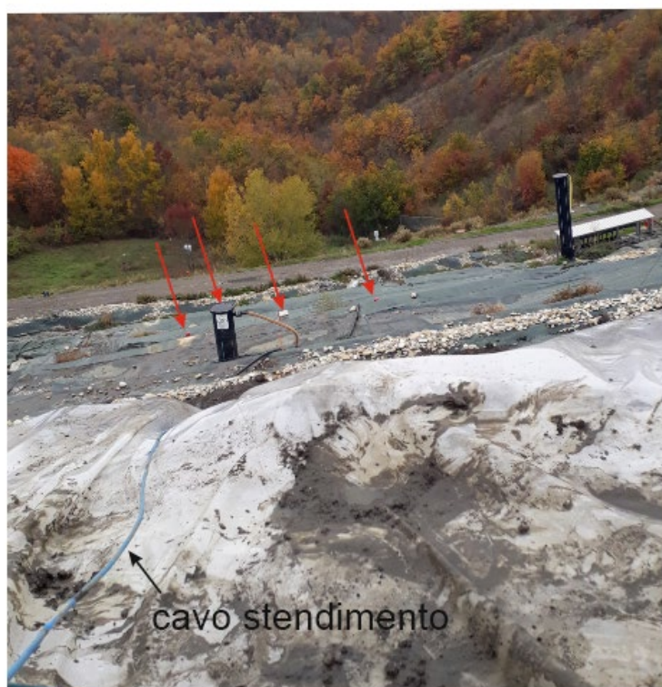
Figura 3 - Particolare lungo ERT 2 – in azzurro si vede il cavo dello stendimento e con le frecce rosse sono indicati i manufatti di monitoraggio e gestione della discarica presenti nelle immediate vicinanze.
