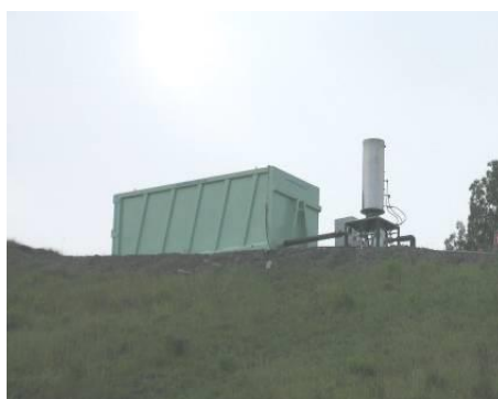
Foto 2: Torcia e biofiltro
