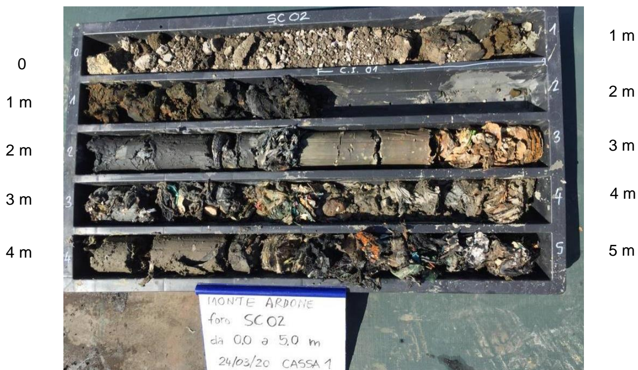
Fig. 7 – Sondaggio SC-02 da 0 a 5 m
