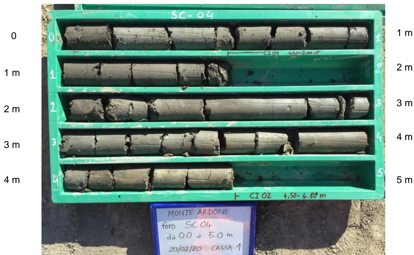
Fig. 11 – Sondaggio SC-04 da 0 a 5 m
