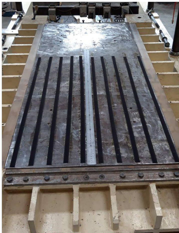
Fig. 6: la piastra di carico predisposta con le strisce di velcro
