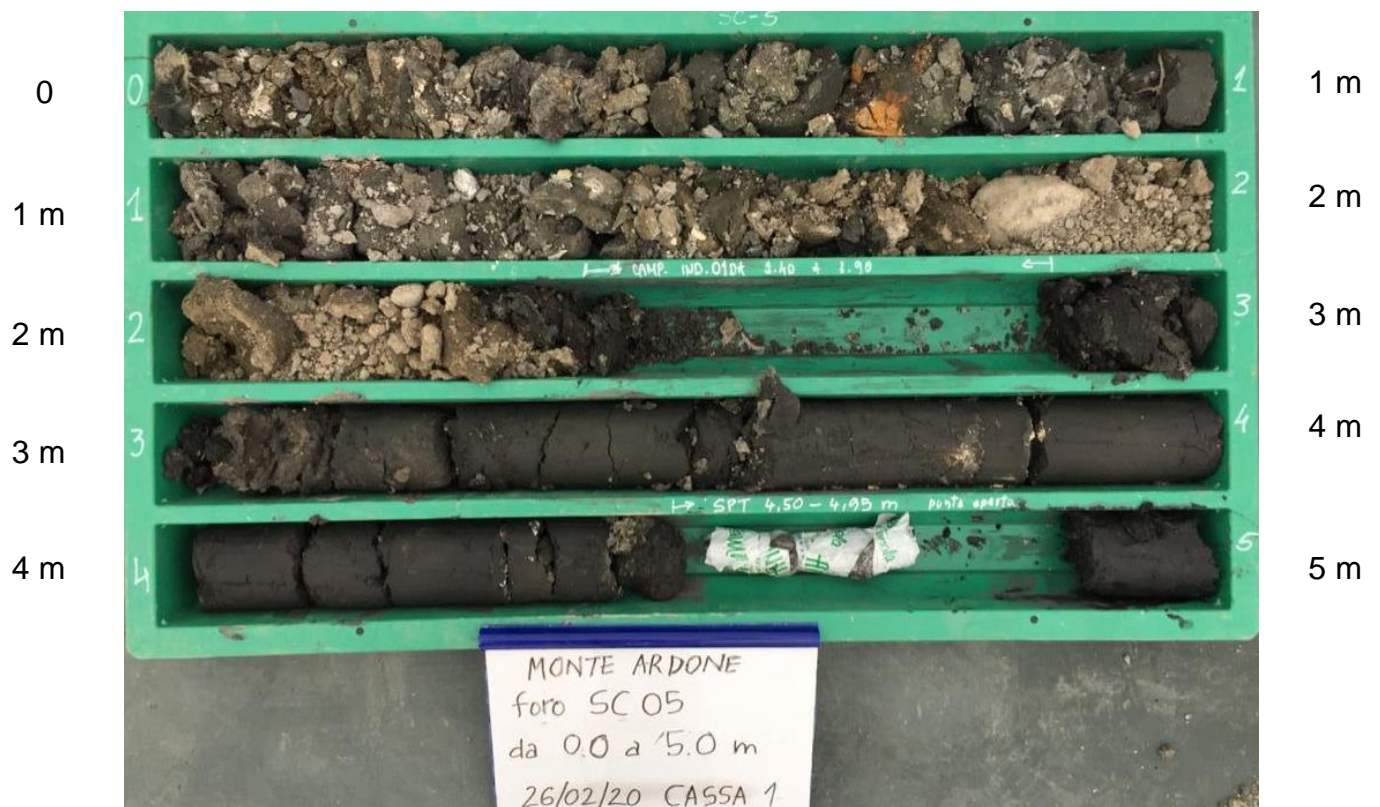
Fig. 15 – Sondaggio SC-05 da 0 a 5 m
