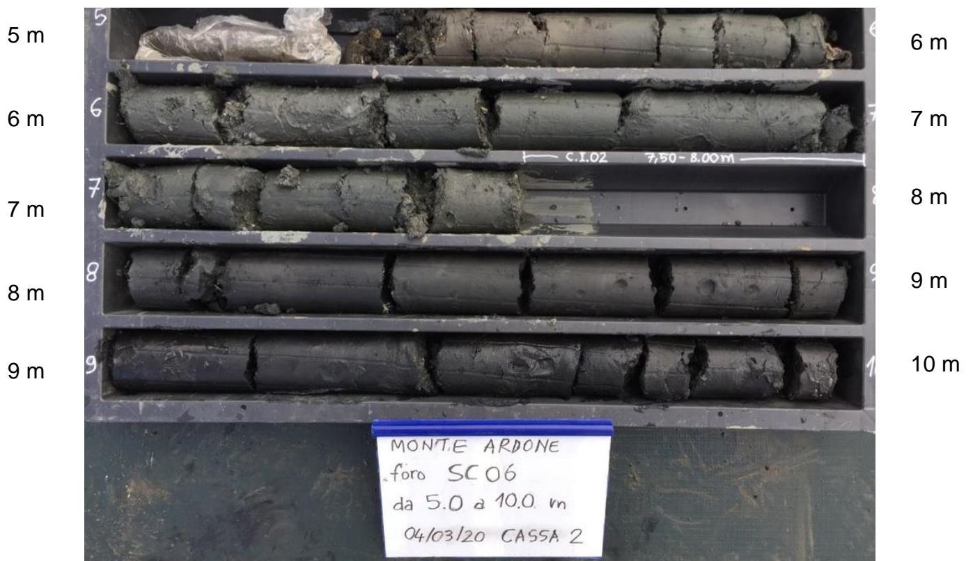
Fig. 18 – Sondaggio SC-06 da 5 a 10 m
