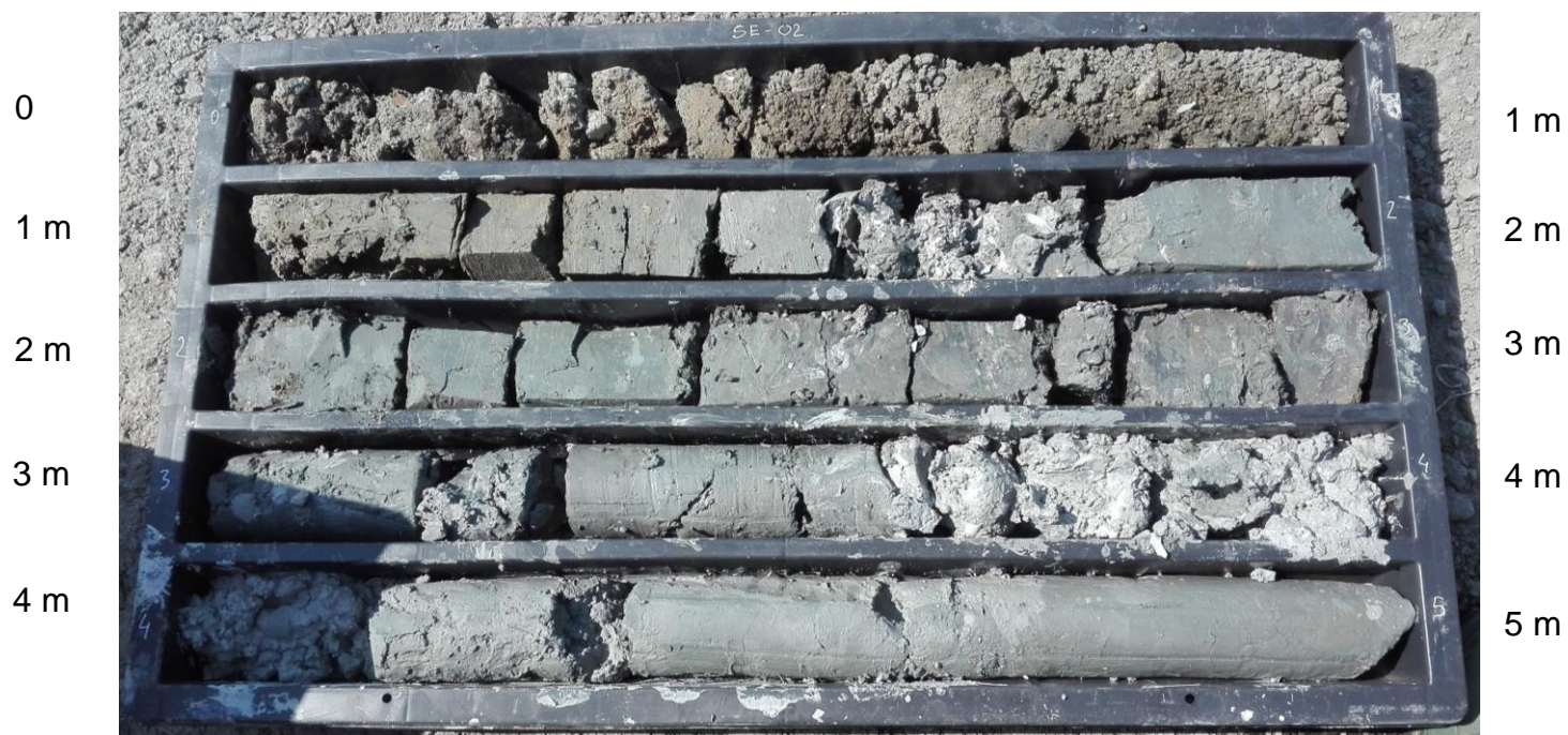
Fig. 29 – Sondaggio SE-02 da 0 a 5 m
