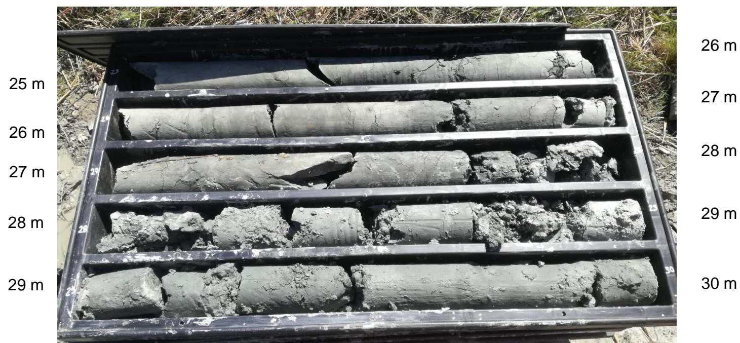
Fig. 6– Sondaggio SC-01 da 25 a 30 m
