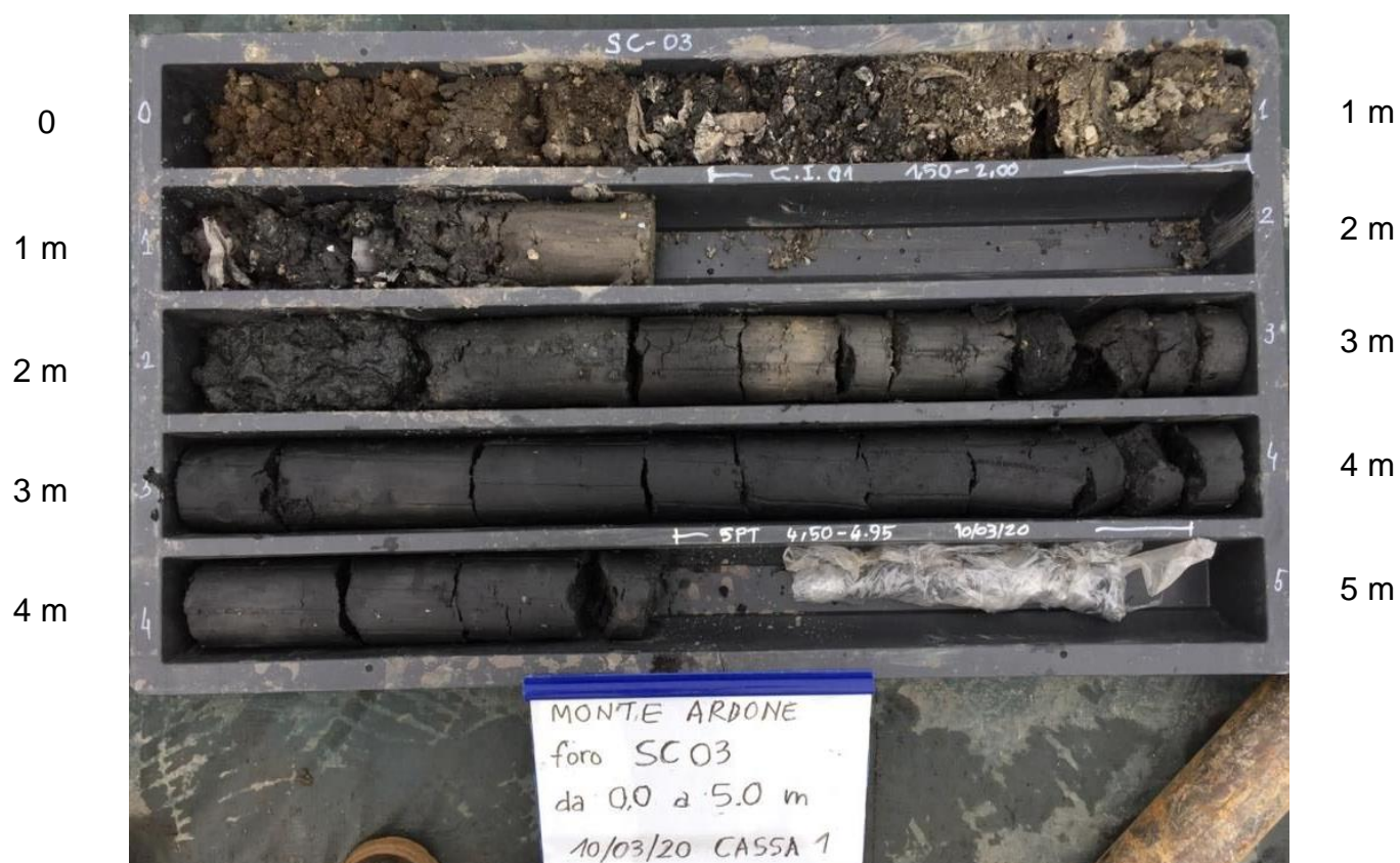
Fig. 9 – Sondaggio SC-03 da 0 a 5 m
