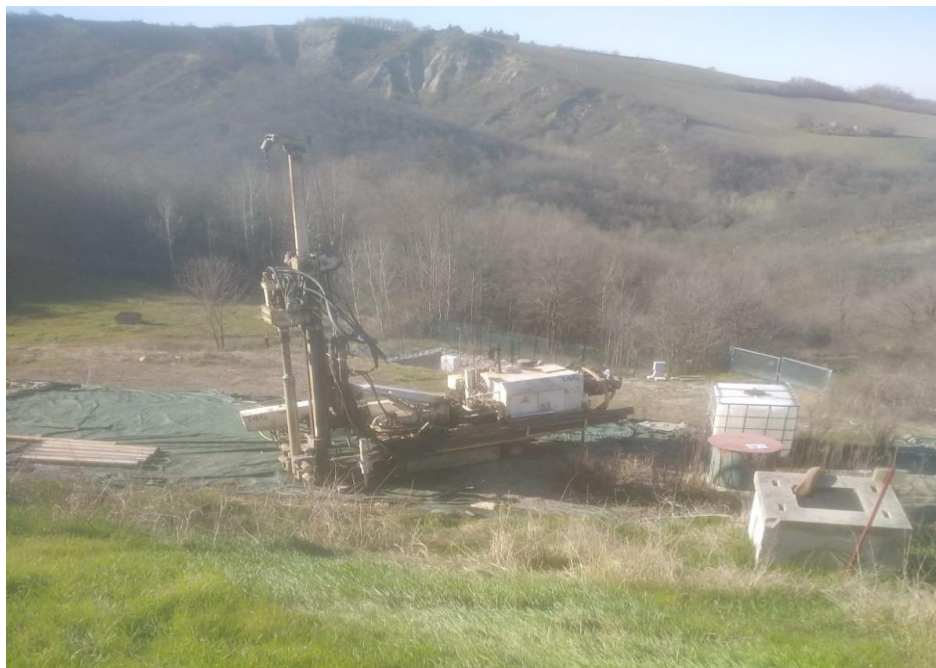
Fig. 3 - Particolare macchina perforatrice Beretta T 46.
