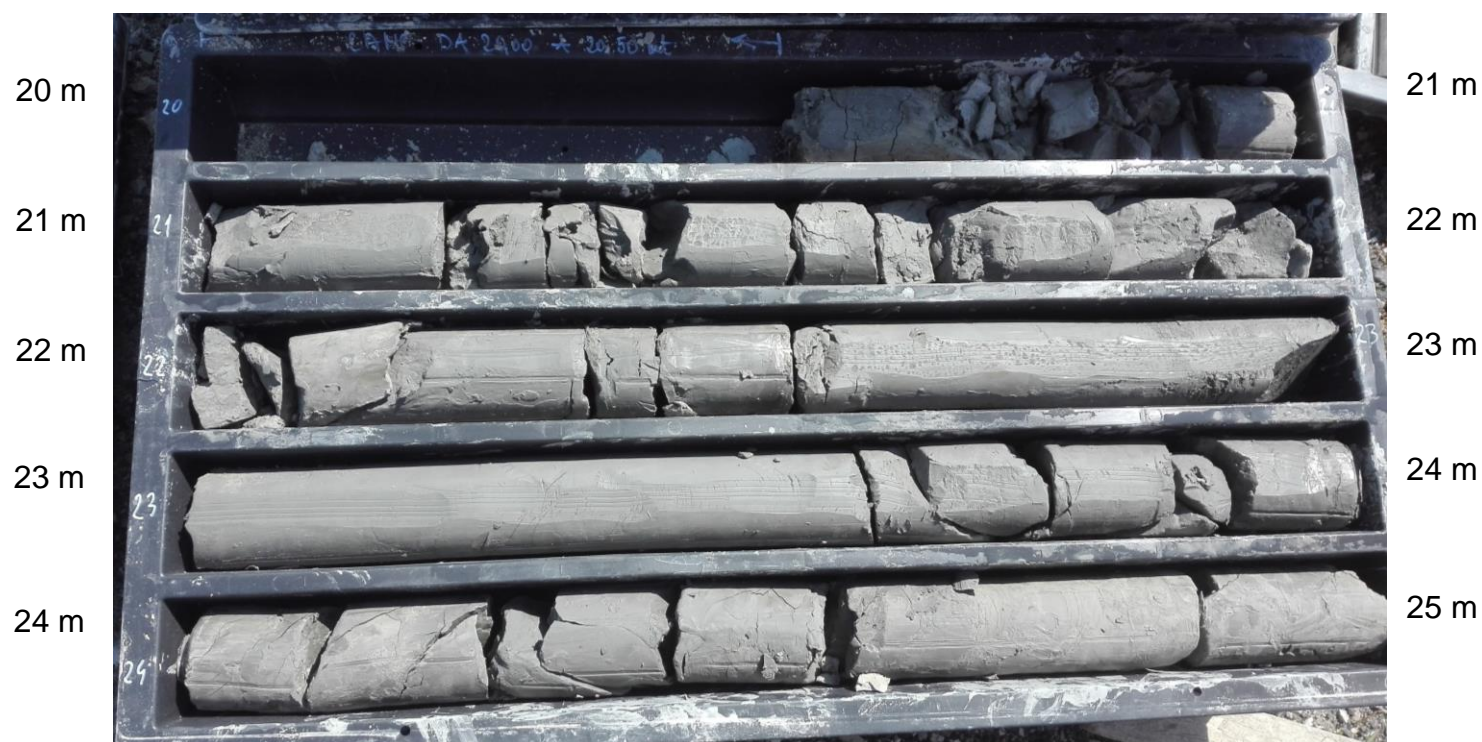
Fig. 24 – Sondaggio SE-01 da 20 a 25 m
