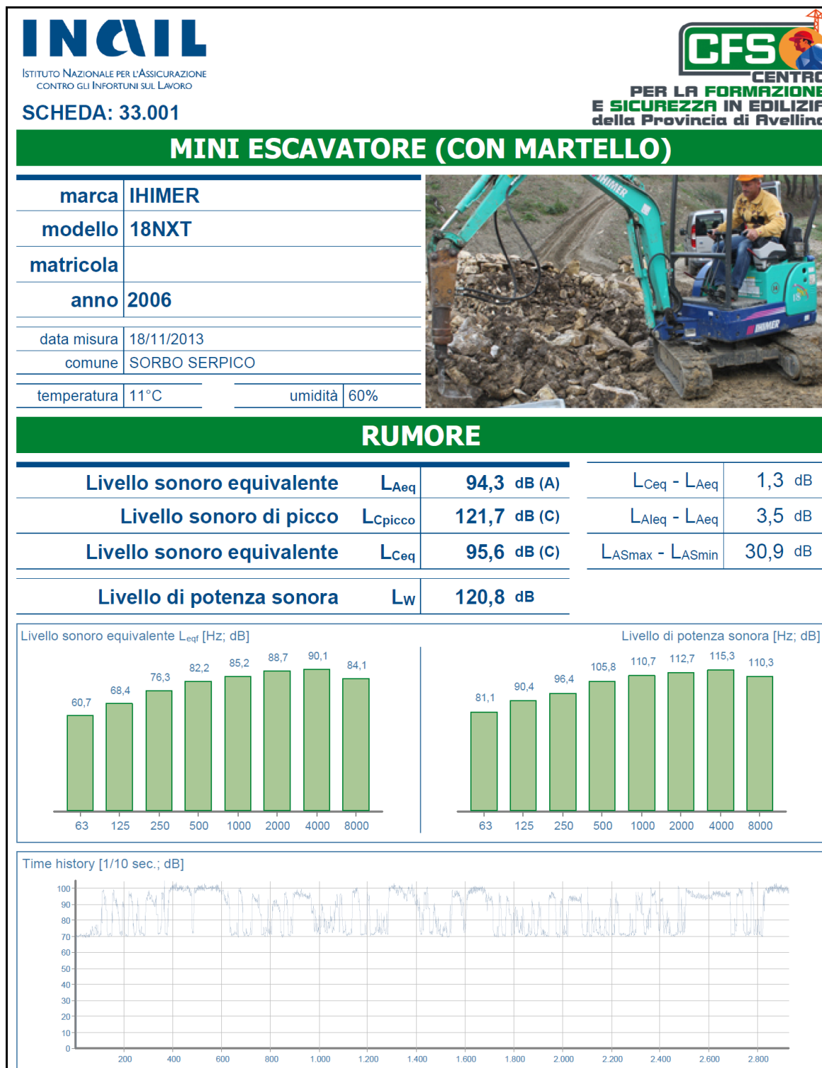
Figura 12: scheda tecnica (sorgente S5, escavatore con demolitore)
