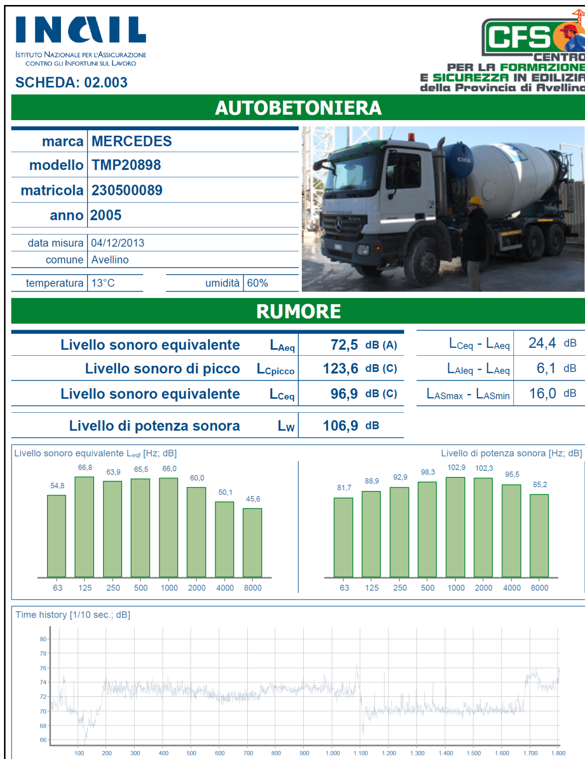
Figura 13: scheda tecnica (sorgente S7, autobetoniera)
