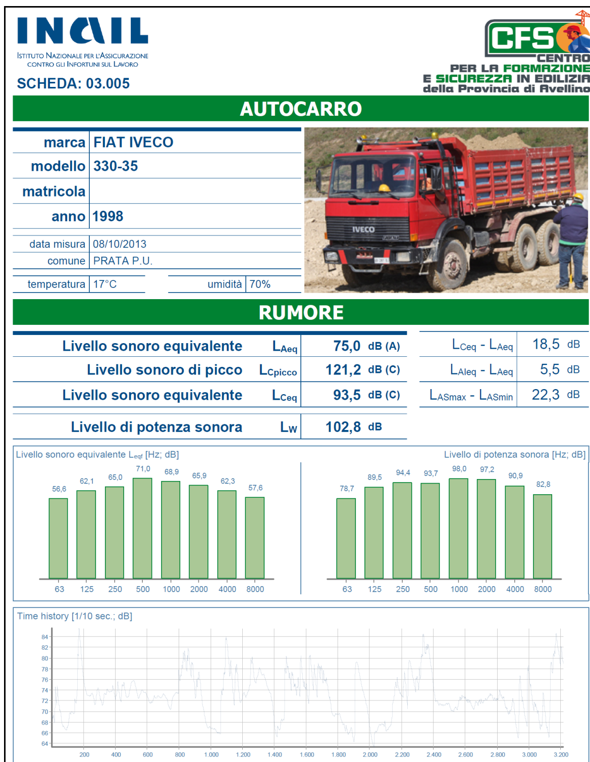
Figura 9: scheda tecnica (sorgente S1, autocarro)
