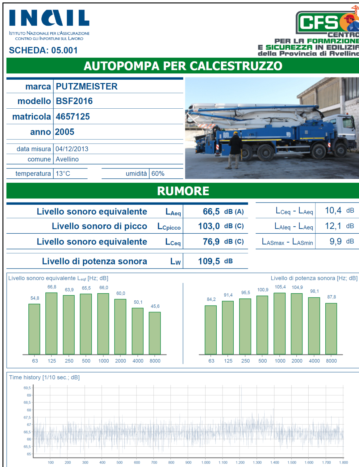
Figura 16: scheda tecnica (sorgente S10, autopompa per calcestruzzo)
