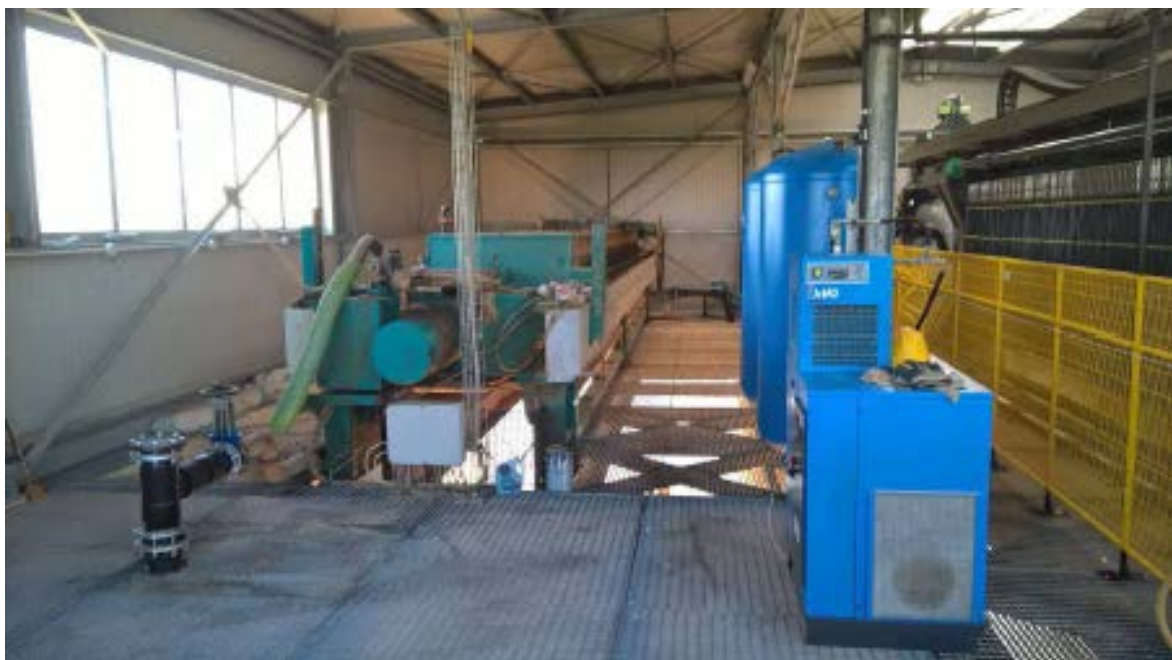
Figura 11 Dettaglio della sorgente S3 (le due filtropresse, a sinistra la vecchia, a destra la nuova GHT 1500).
