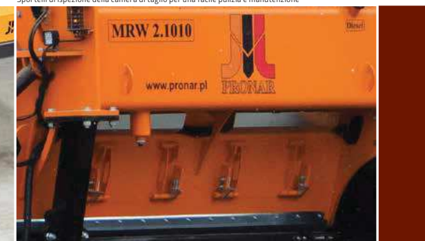
Sportelli di ispezione della camera di taglio per una facile pulizia e manutenzione
