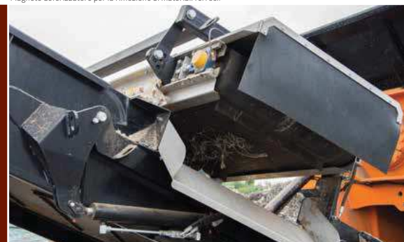
Magnete deferizzatore per la rimozione di materiali ferrosi.
