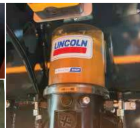
Sistema di lubrificazione centralizzata garantisce la ottima lubrificazione delle parti più importanti della macchina
