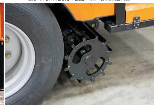
MRW 2.85 SELF CRAWLER - sistema autonomo di movimentazione
