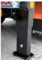
Staffe di sostegno idrauliche garantiscono la stabilità della macchina
