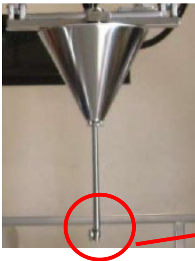
Figura 6 – Testina rotante di spruzzamento
