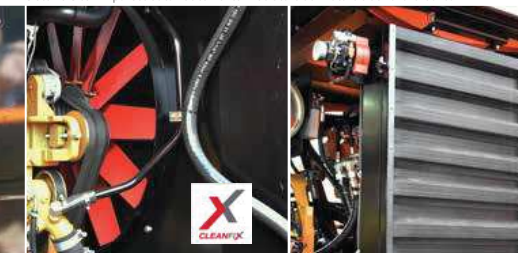
Sistema Cleanfix pulisce automaticamente il radiatore del motore e dell'olio idraulico
