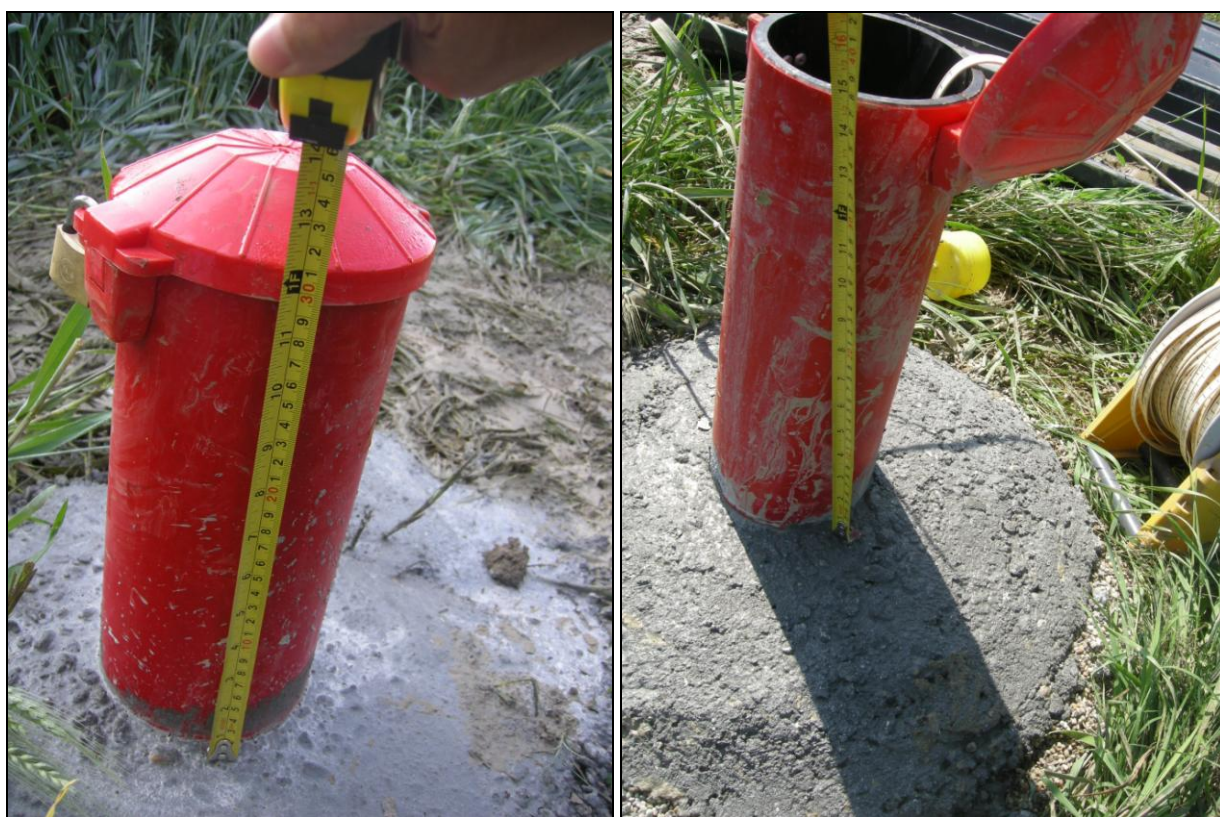
Figura 2.5: Chiusino a protezione dei piezometri Pm1 e Pm3
