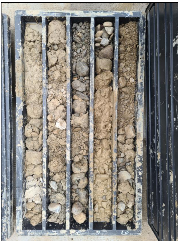
Fig. 2.5 - Pm1: Carote di terreno da -5.0 a -10.0 m
