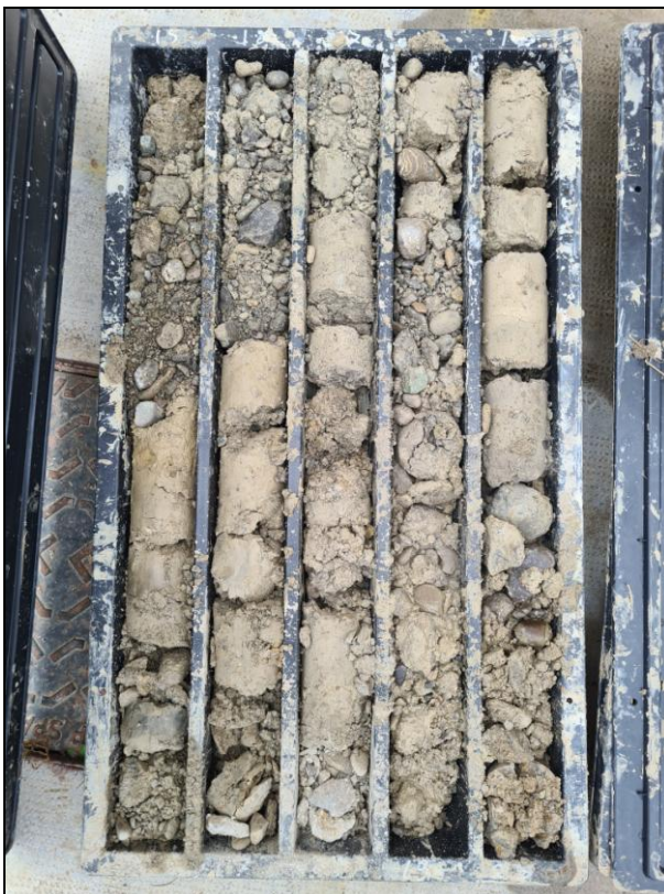
Fig. 2.7 - Pm1: Carote di terreno da -15.0 a -20.0 m
