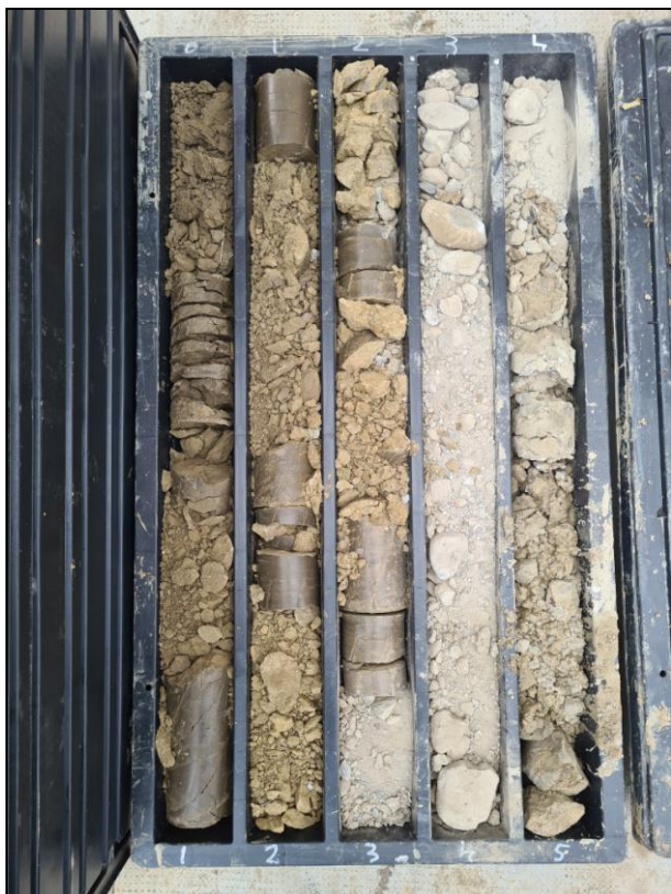
Fig. 2.4 - Pm1: Carote di terreno da 0.0 a -5.0 m
