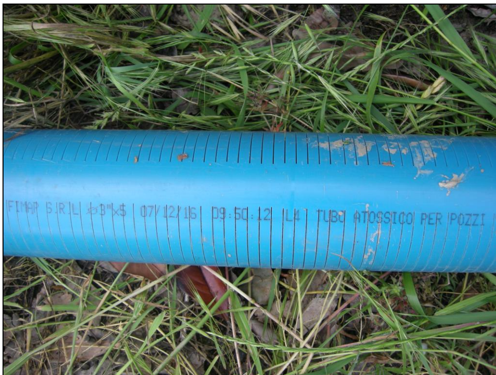
Figura 2.12: Tubo piezometrico atossico installato all'interno dei fori di sondaggio Pm1 e Pm3
