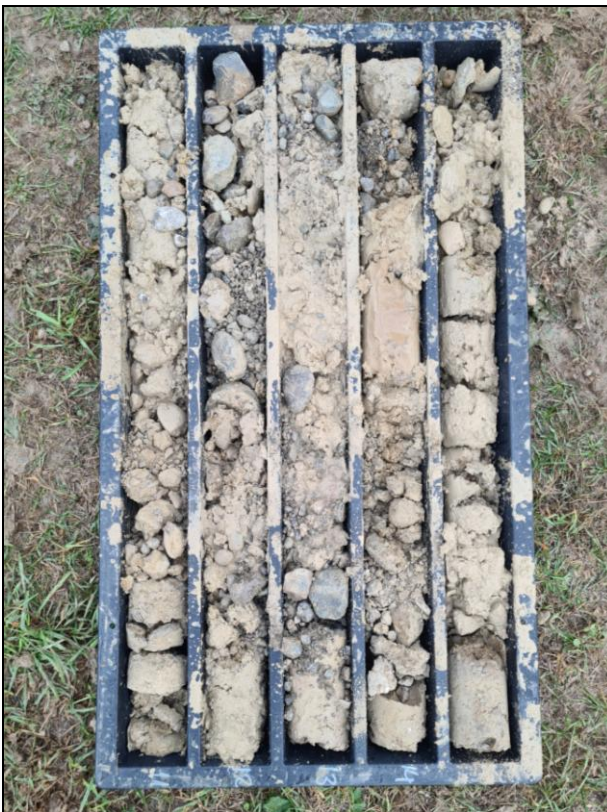
Fig. 2.10 - Pm3: Carote di terreno da -10.0 a -15.0 m
