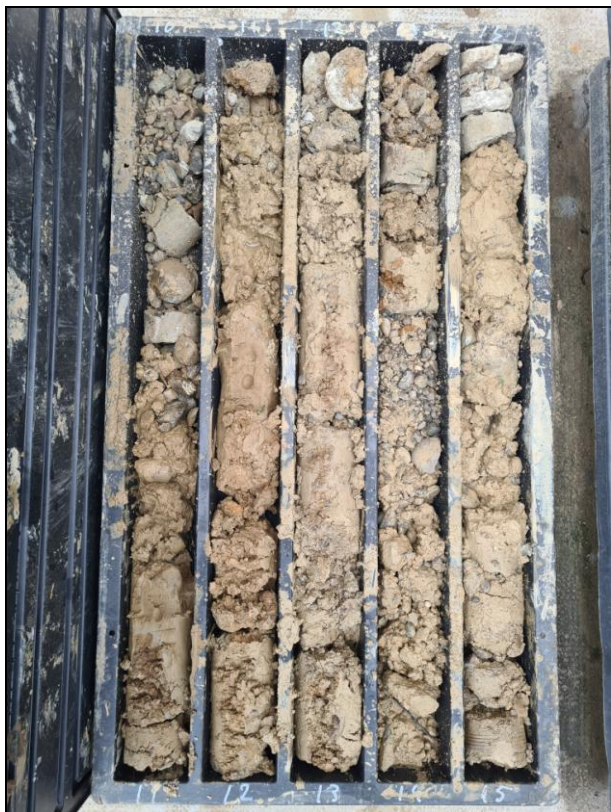
Fig. 2.6 - Pm1: Carote di terreno da -10.0 a -15.0 m
