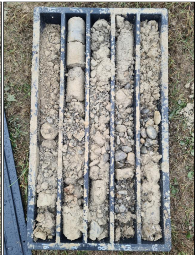
Fig. 2.11 - Pm3: Carote di terreno da -15.0 a -20.0 m
