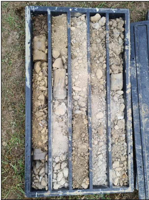
Fig. 2.8 - Pm3: Carote di terreno da 0.0 a -5.0 m
