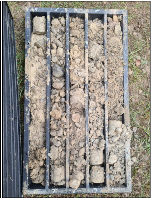
Fig. 2.9 - Pm3: Carote di terreno da -5.0 a -10.0 m
