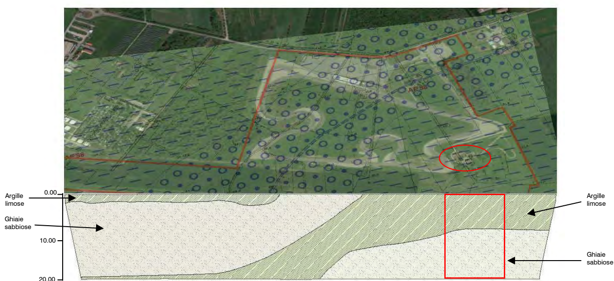
Fig. 6: Sovrapposizione carta geologica CARG Regione Emilia Romagna e profili stratigrafici delle unità geologiche identificate.
