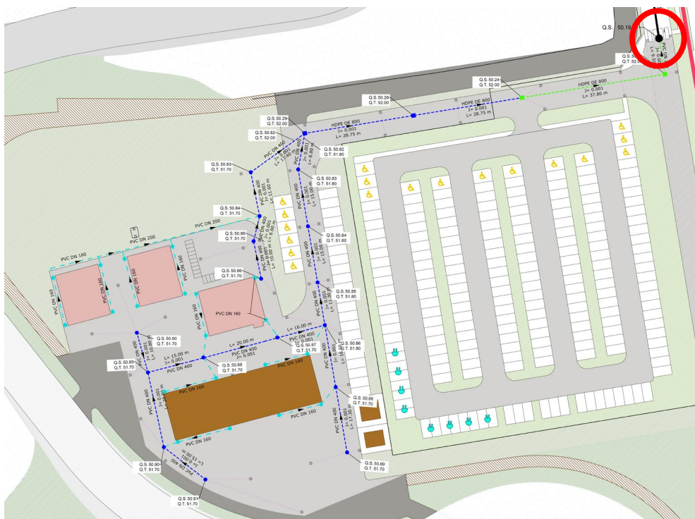
Figura-3: Rete di smaltimento acque meteoriche PDC 2
