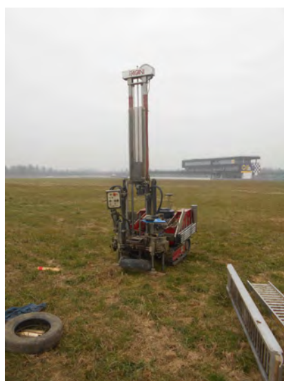
Fig. 5.1: Penetrometro utilizzato per eseguire le prove penetrometriche nell'area di interesse.
