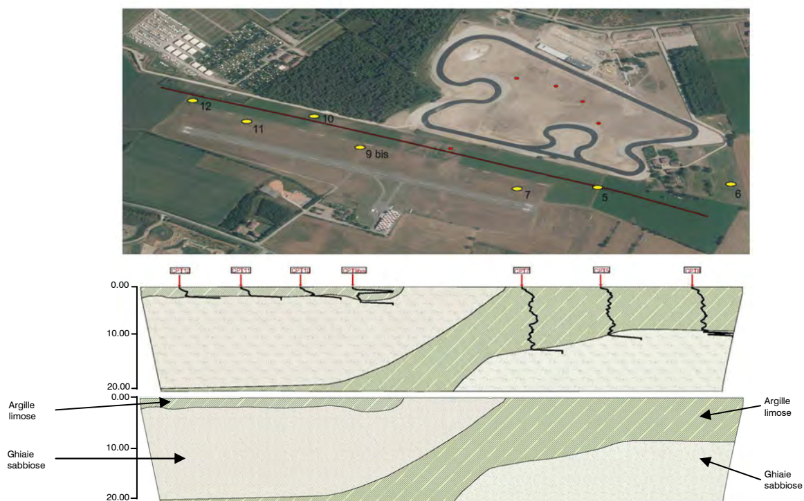
Fig. 7.3: Profili stratigrafici delle unità geologiche identificate, rapportati con e senza le prove penetrometriche CPT.
