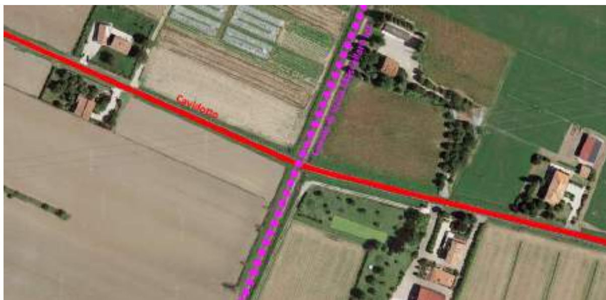
Figura 18. Zoom in corrispondenza dell'interferenza F (insezione canale di scolo Mascellaro Inferiore), superamento tramite TOC (Tipico 6)
