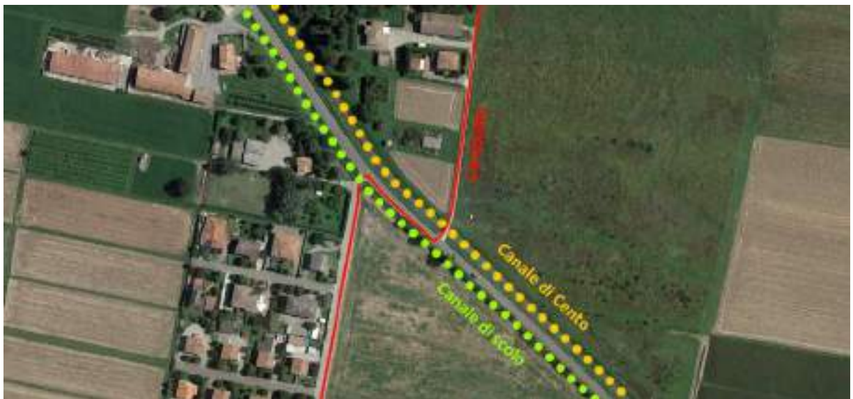
Figura 11. Zoom in corrispondenza delle interferenze A (canale di scolo via delle Viole) e B (canale di Cento). Entrambi i canali vengono superati con la TOC del Tipico 6.
