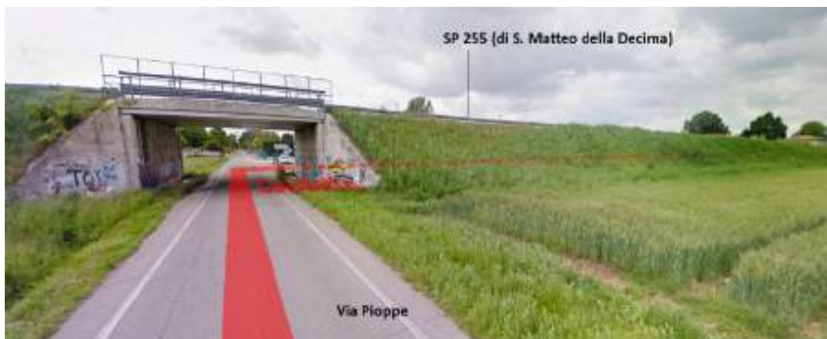
Figura 25. Passaggio cavidotto parallelo al avalcavia tra SP 255 (di S. Matteo della Decima) via Pioppe
