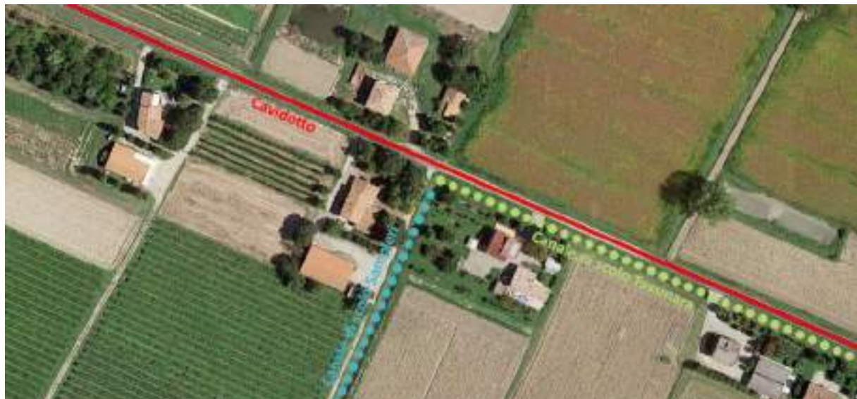
Figura 14. Zoom in corrispondenza delle interferenze C (prossimità a canale di scolo Sampieri) e D (parallelismo con canale di scolo Tassinara). Il cavidotto non interagisce direttamente con il canale, che rimane fuori dalla fascia di rispetto del cavidotto (figura 2).
