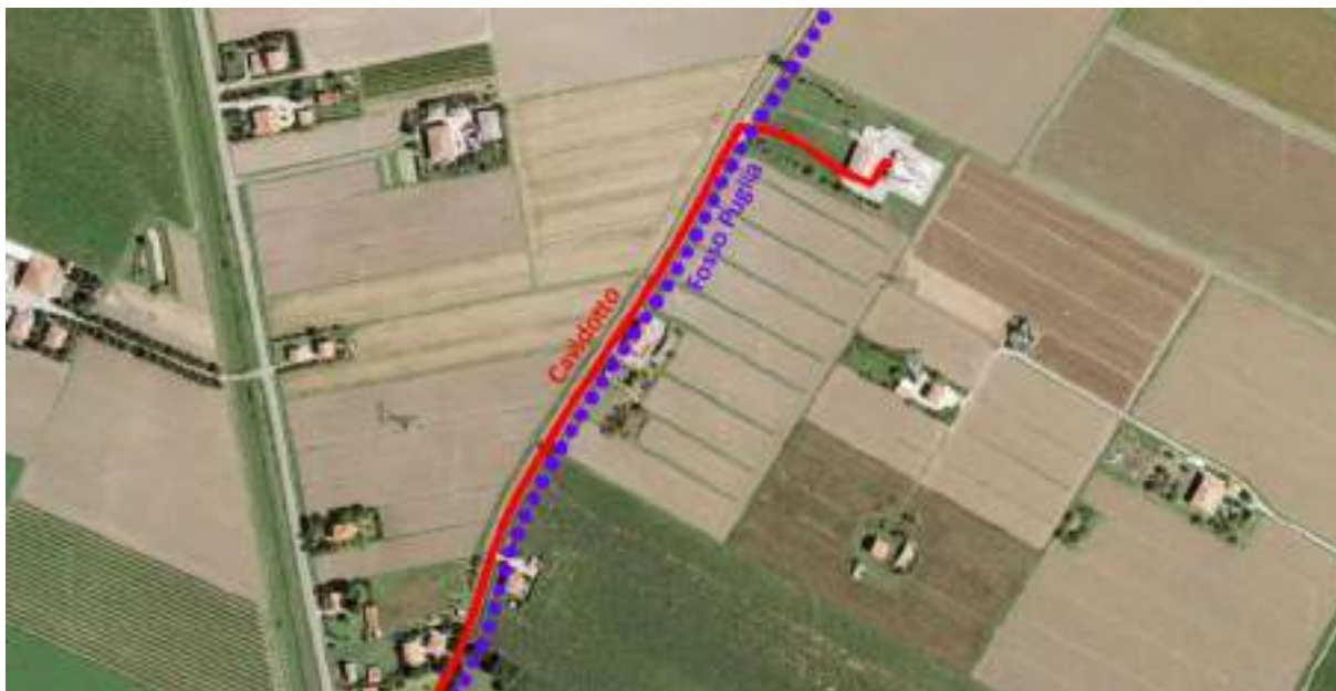
Figura 22. Zoom in corrispondenza delle interferenza J (parallelismo con fosso Puglia) e K (intersezione con fosso Puglia), superamento tramite utilizzo della tubazione E-distribuzione esistente
