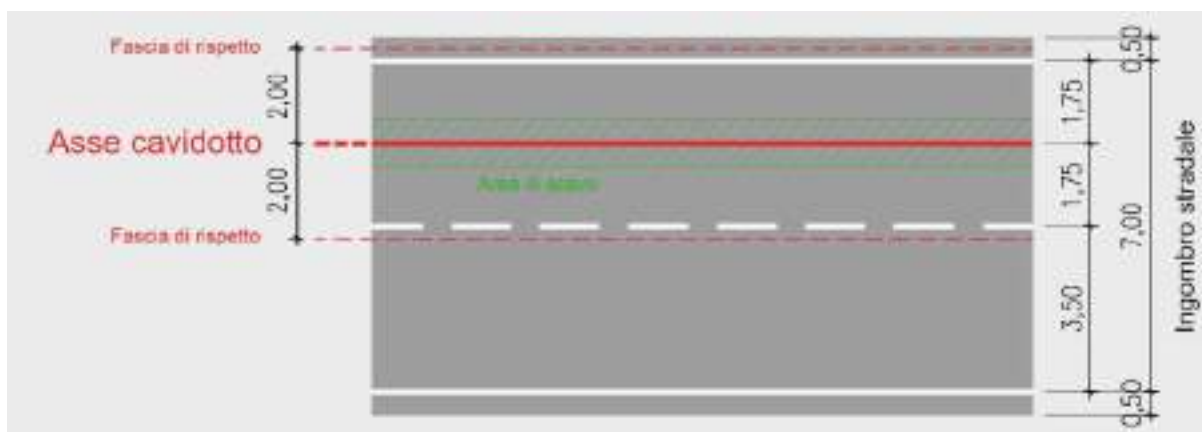
Figura 2. Schema esplicativo della fascia di rispetto del cavidotto
