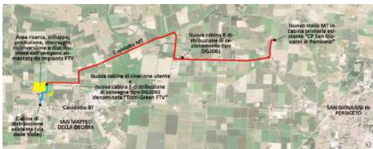
Figura 1. Schema di funzionamento del cavidotto sovrapposto a foto satellitare: si mostrano i 2 tratti principali del cavidotto e le cabine nuove ed esistenti da esso interconnesse
