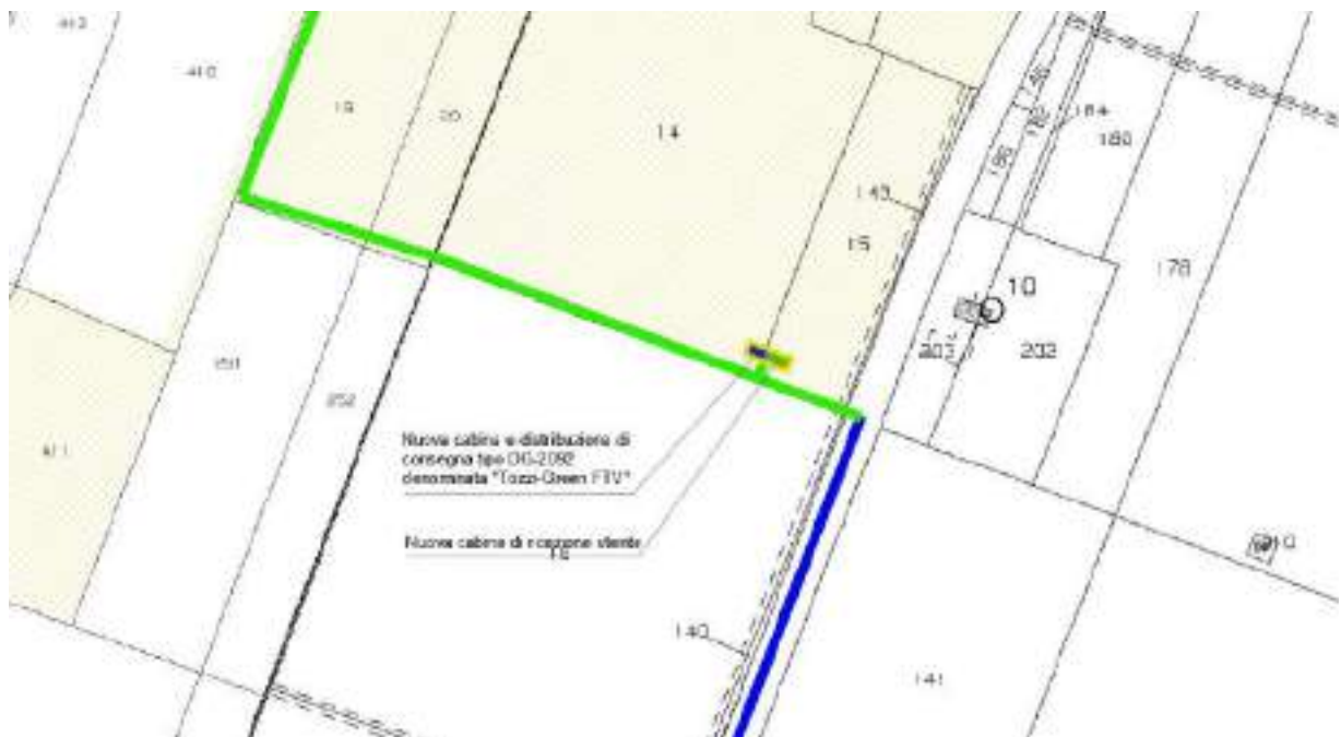
Figura 3. Posizionamento nuova cabina di consegna E-distribuzione e nuova cabina di ricezione utente all'interno del centro di ricerca, produzione, riconversione e distribuzione dell'idrogeno con campo FTV e fasce di rispetto in giallo
