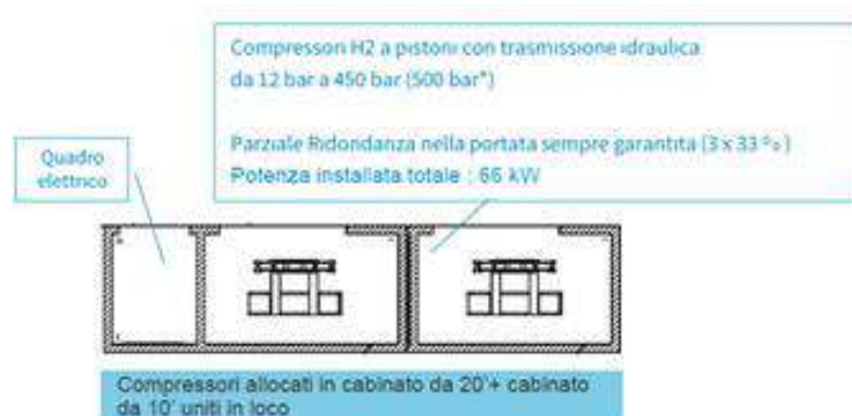
Figura 14. Configurazione tipica del container "compressione"(immagine esemplificativa)
