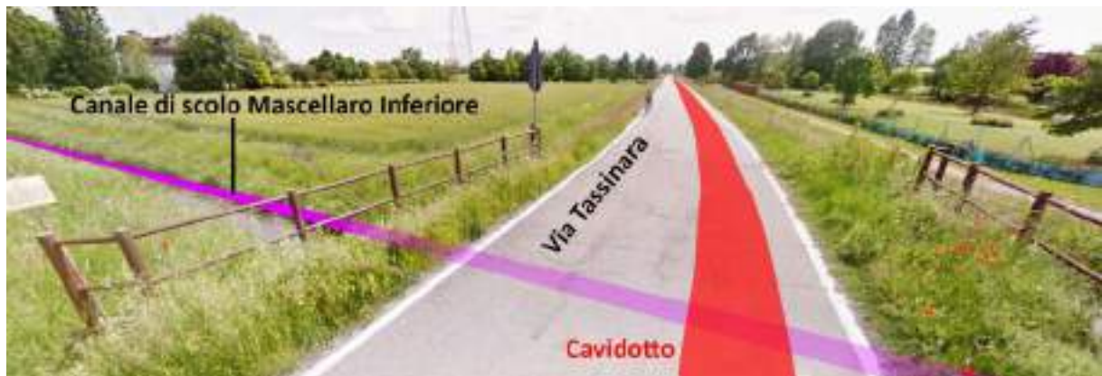
Figura 19. Iinterferenza F (inersezione canale di scolo Mascellaro Inferiore), superamento tramite TOC (Tipico 6)
