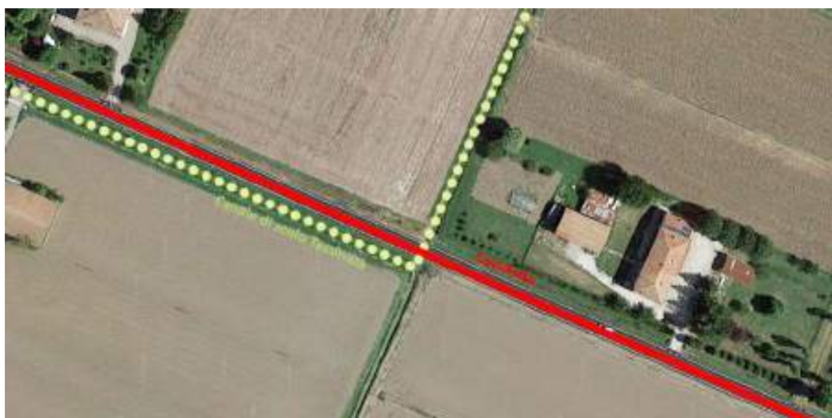
Figura 16. Zoom in corrispondenza dell'interferenza E (insezione canale di scolo Tassinara), superamento tramite TOC (Tipico 6)
