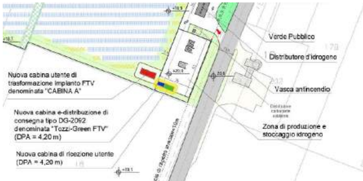
Figura 3. Posizionamento nuova cabina di consegna E-distribuzione e nuova cabina di ricezione utente all'interno del centro di ricerca, produzione, riconversione e distribuzione dell'idrogeno con campo FTV e fasce di rispetto in giallo
