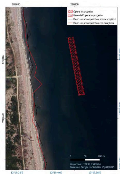
Figura 5.23. Simulazione dell'evoluzione della linea di riva considerando l'attacco del moto ondoso di un anno significativo, con e senza la scogliera (proiezione UTM33/WGS84).
