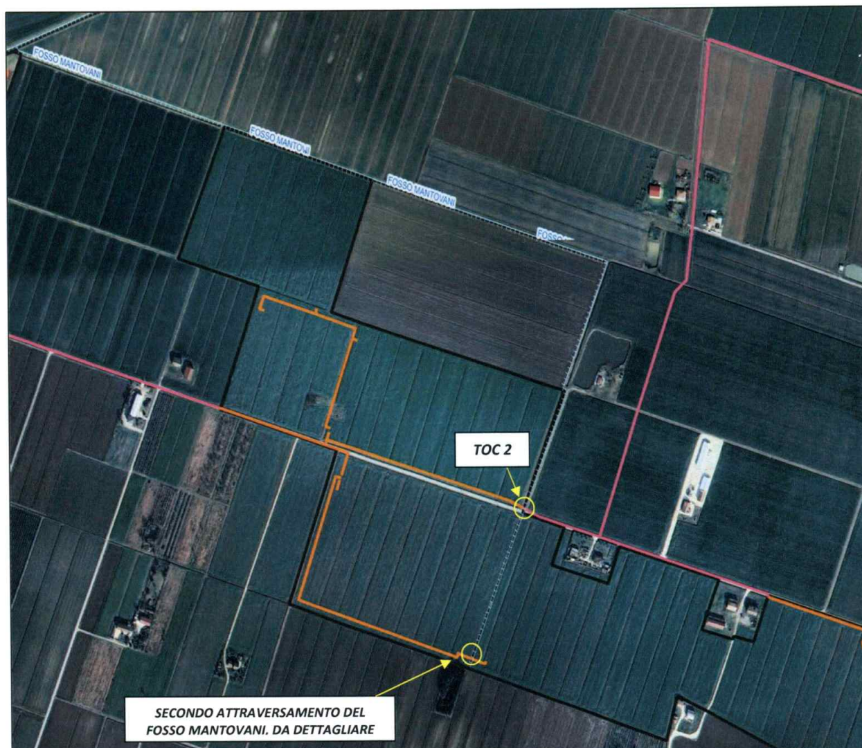
FIGURA 1: INTERFERENZE CON IL FOSSO MANTOVANI (ATTRAVERSAMENTI SUBALVEO)
