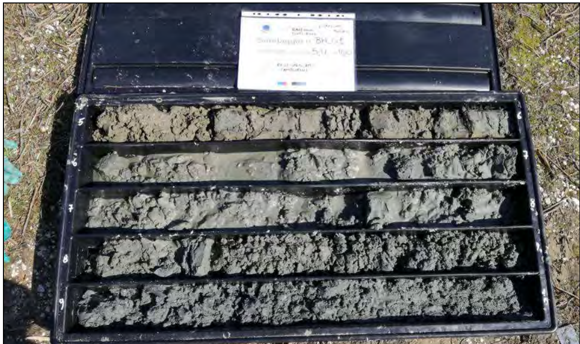
Fig. 3. Carote del tratto tra 5,0m e 10,0m da p.c. del sondaggio BH-01.
