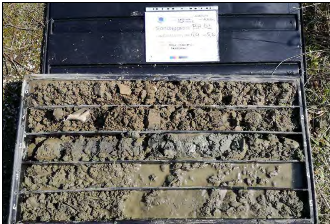
Fig. 2. Carote del tratto tra 0,0m e 5,0m da p.c. del sondaggio BH-01.
