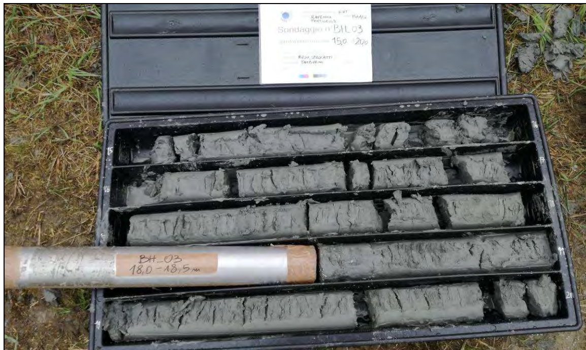
Fig. 24. Carote del tratto compreso tra 15,0m e 20,0m da p.c. del sondaggio BH-03. Campione indisturbato di tipo Shelby (BH-03 Sh1) prelevato tra 18,0m e 18,5m da p.c.
