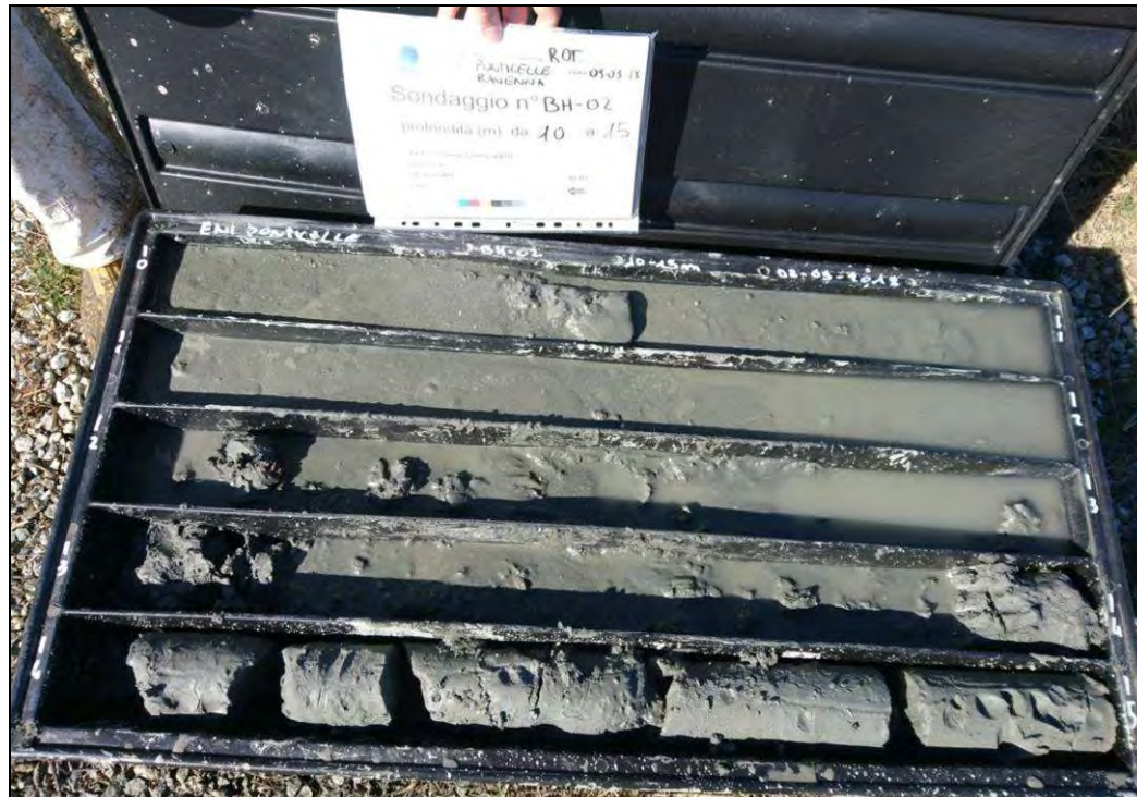
Fig. 13. Carote del tratto compreso tra 10,0m e 15,0m da p.c. del sondaggio BH-02.
