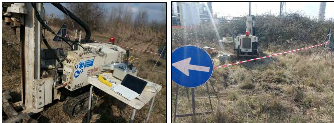
Fig. 30. Esecuzione della prova CPTU-01, piazzamento della sonda (Geoprobe Gaia), segnaletica di sicurezza e delimitazione dell'area con nastro B/R.
