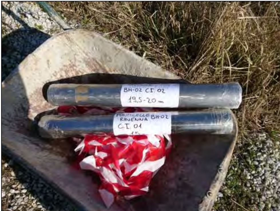
Fig. 18. Campioni indisturbati di tipo Shelby (Sh-01, Sh-02) prelevati durante il sondaggio BH-02.
