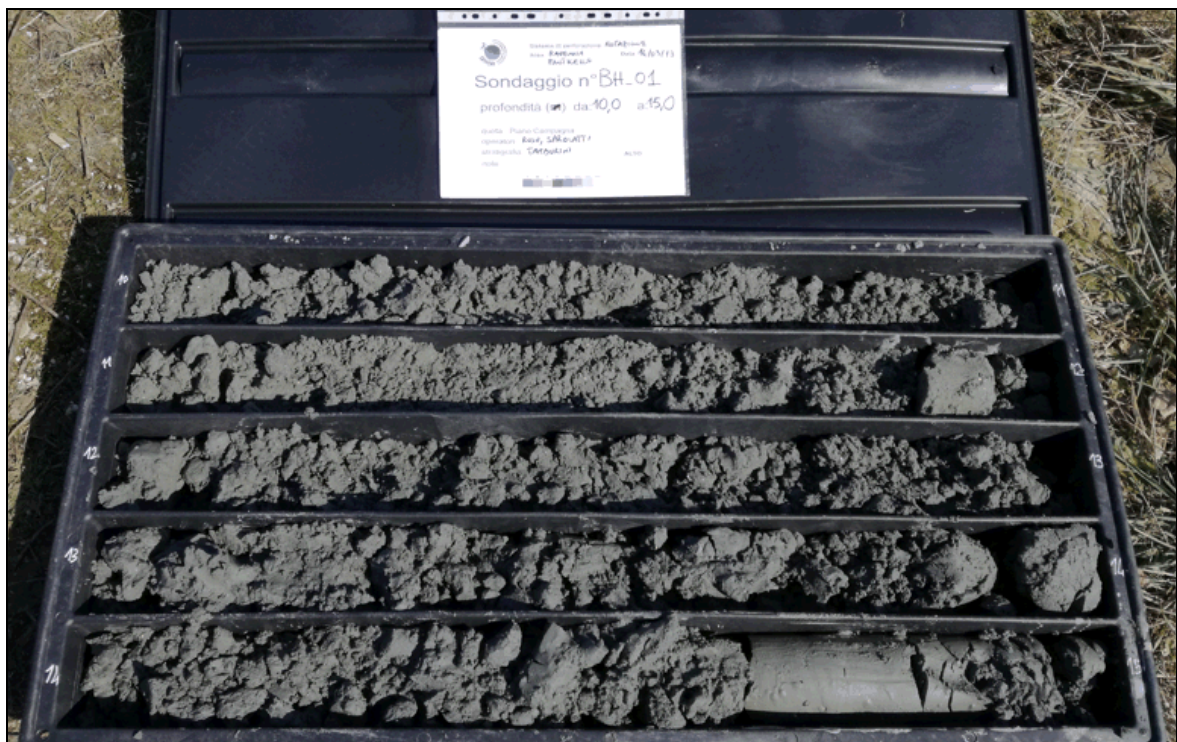
Fig. 4. Carote del tratto tra 10,0m e 15,0m da p.c. del sondaggio BH-01.
