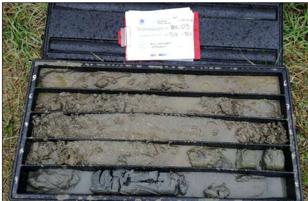
Fig. 22. Carote del tratto compreso tra 5,0m e 10,0m da p.c. del sondaggio BH-03
