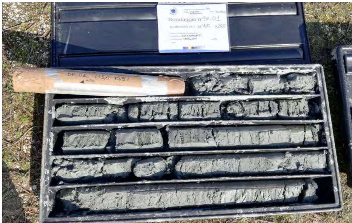
Fig. 5. Carote del tratto tra 15,0m e 20,0m da p.c. del sondaggio BH-01. Campione indisturbato di tipo Shelby (BH-01 Sh1) prelevato tra 15,0m e 15,5m da p.c.
