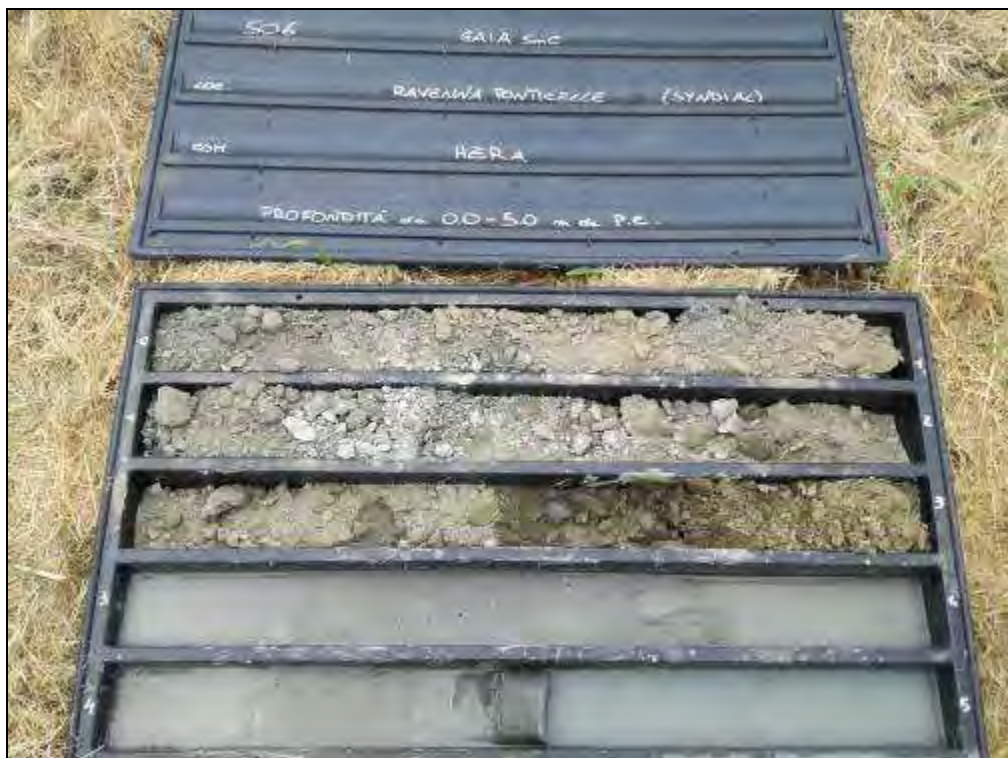
Fig. 43. Carote del tratto compreso tra 0,0m e 5,0m da p.c. del sondaggio S06
