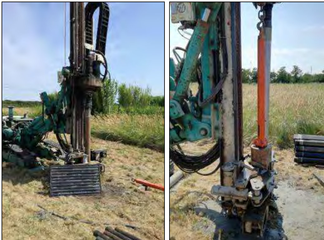
Fig.34. Posizionamento ed esecuzione SPT sondaggio S05 con sonda Gaia.
