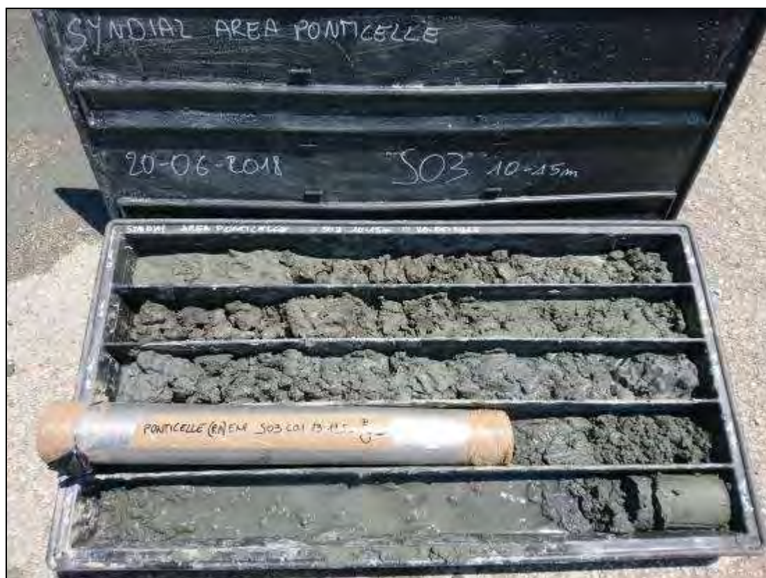
Fig. 21. Carote del tratto compreso tra 10,0m e 15,0m da p.c. del sondaggio S03.
