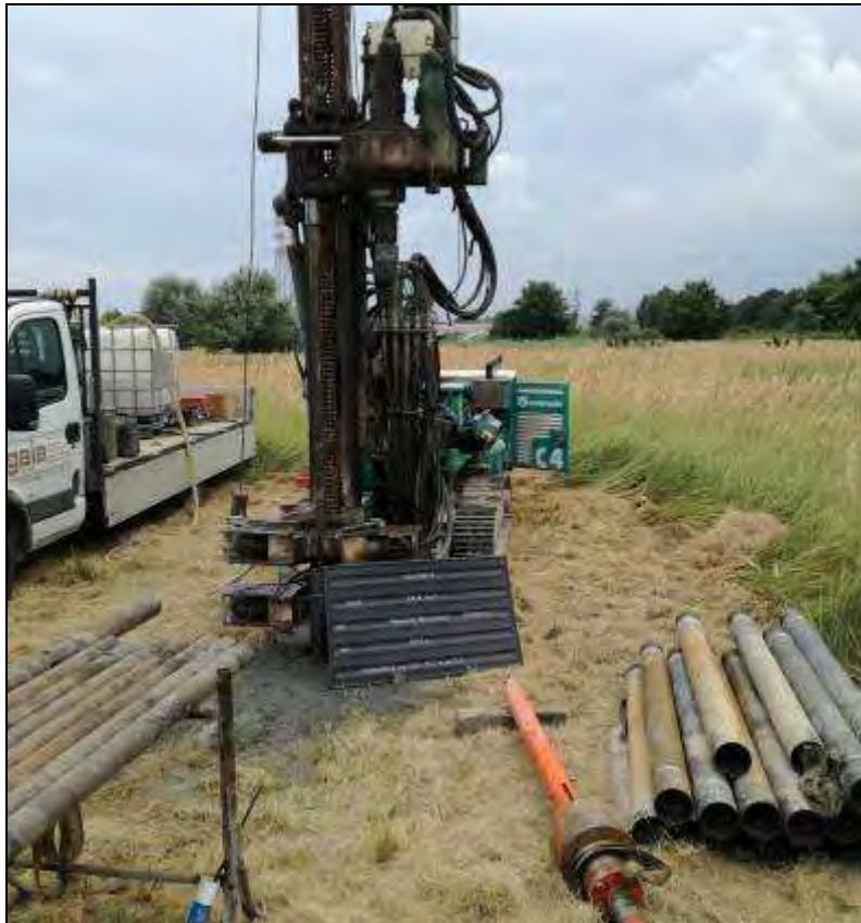
Fig.42. Posizionamento ed esecuzione SPT sondaggio S06 con sonda Gaia.
