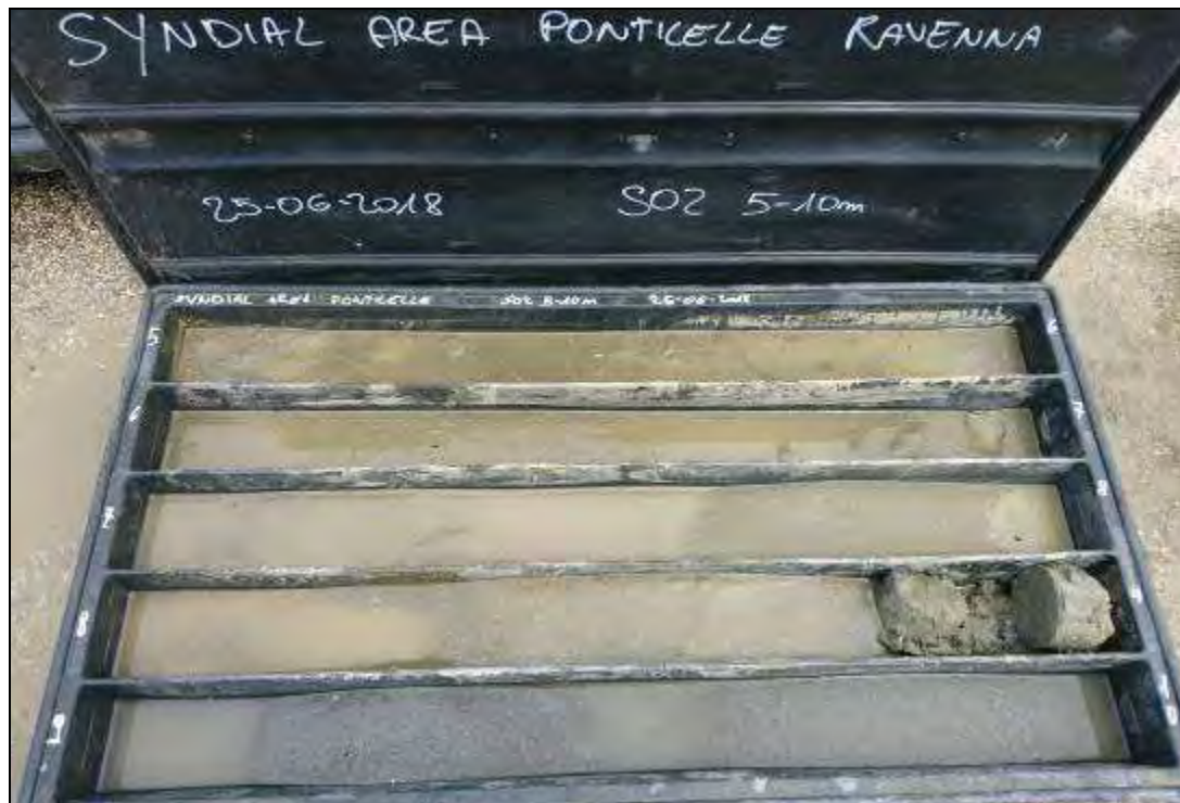
Fig. 11. Carote del tratto compreso tra 5,0m e 10,0m da p.c. del sondaggio S02.
