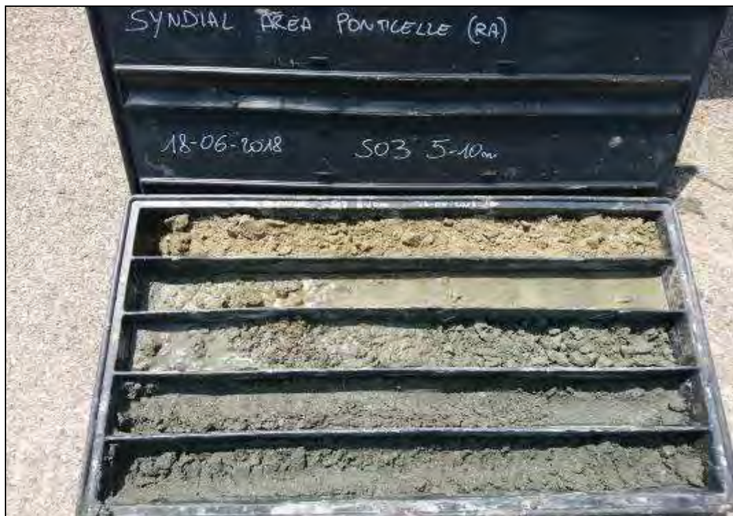
Fig. 20. Carote del tratto compreso tra 5,0m e 10,0m da p.c. del sondaggio S03
