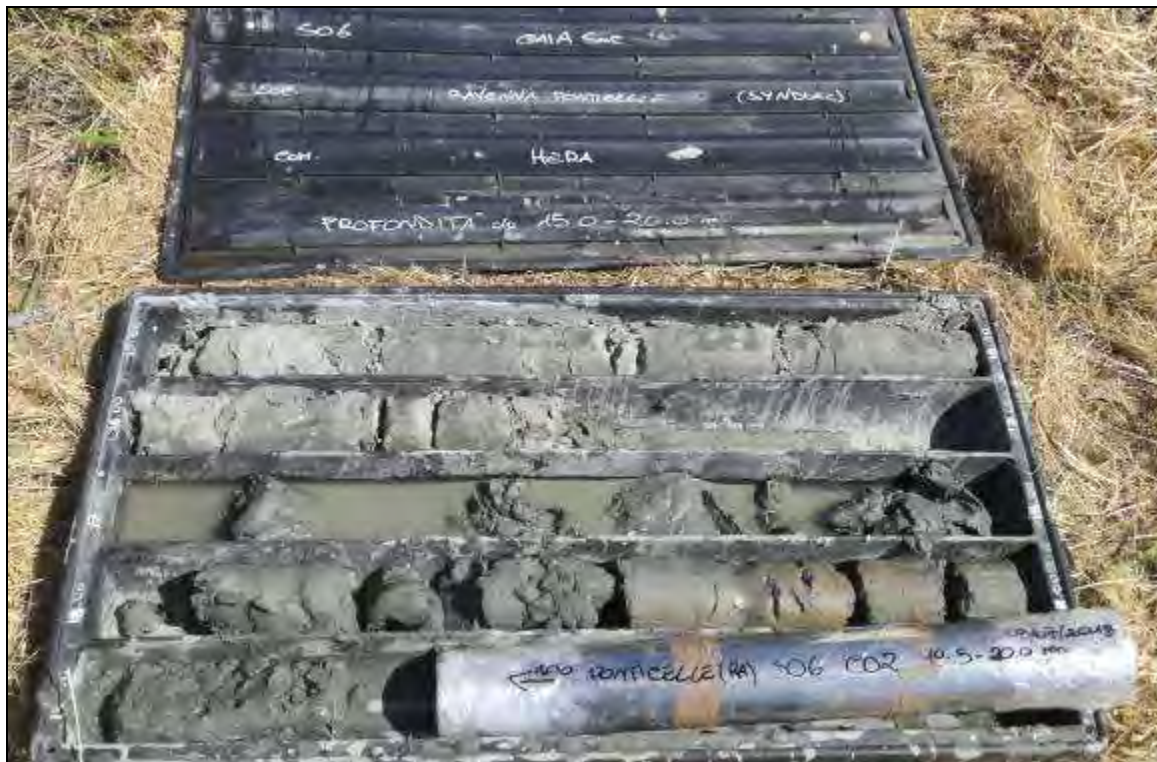
Fig. 46. Carote del tratto compreso tra 15,0m e 20,0m da p.c. del sondaggio S06.
