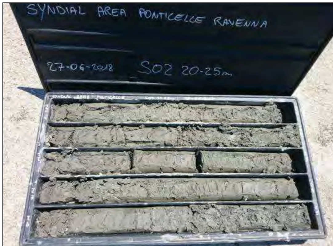
Fig. 14. Carote del tratto compreso tra 20,0m e 25,0m da p.c. del sondaggio S02.
