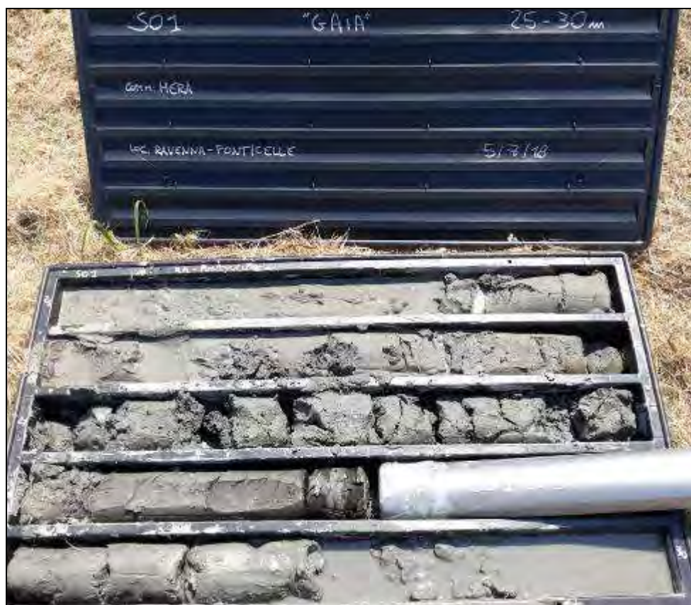
Fig. 7. Carote del tratto compreso tra 25,0m e 30,0m da p.c. del sondaggio S01.
