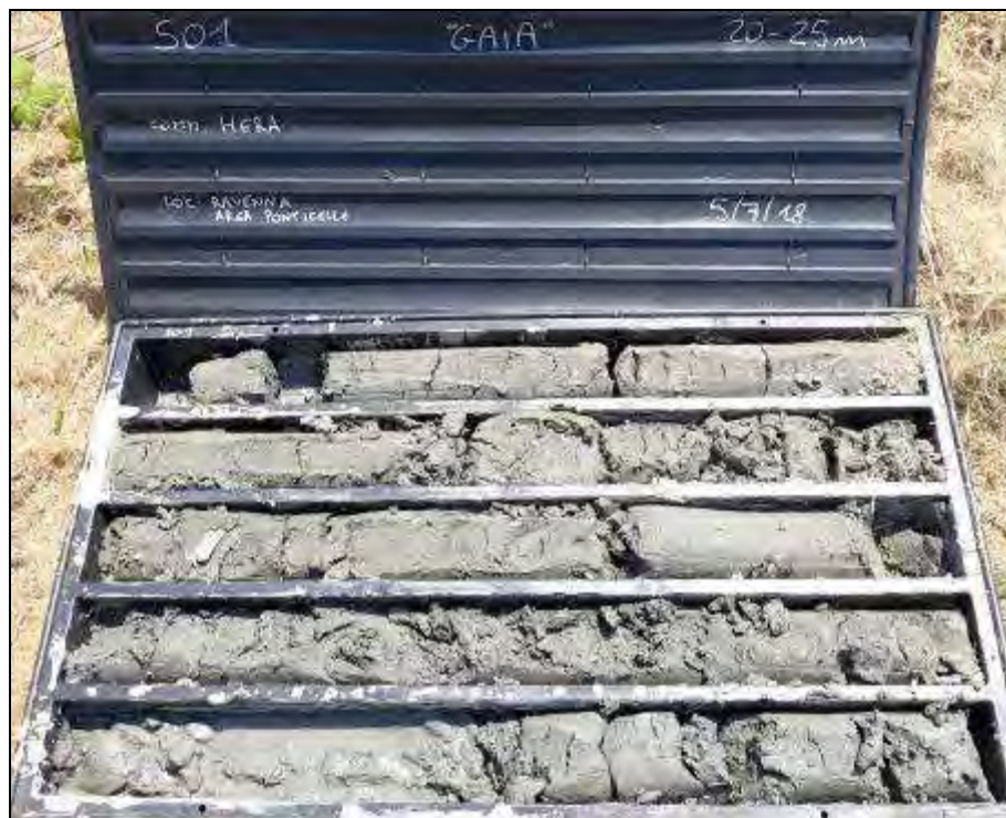
Fig. 6. Carote del tratto compreso tra 20,0m e 25,0m da p.c. del sondaggio S01.
