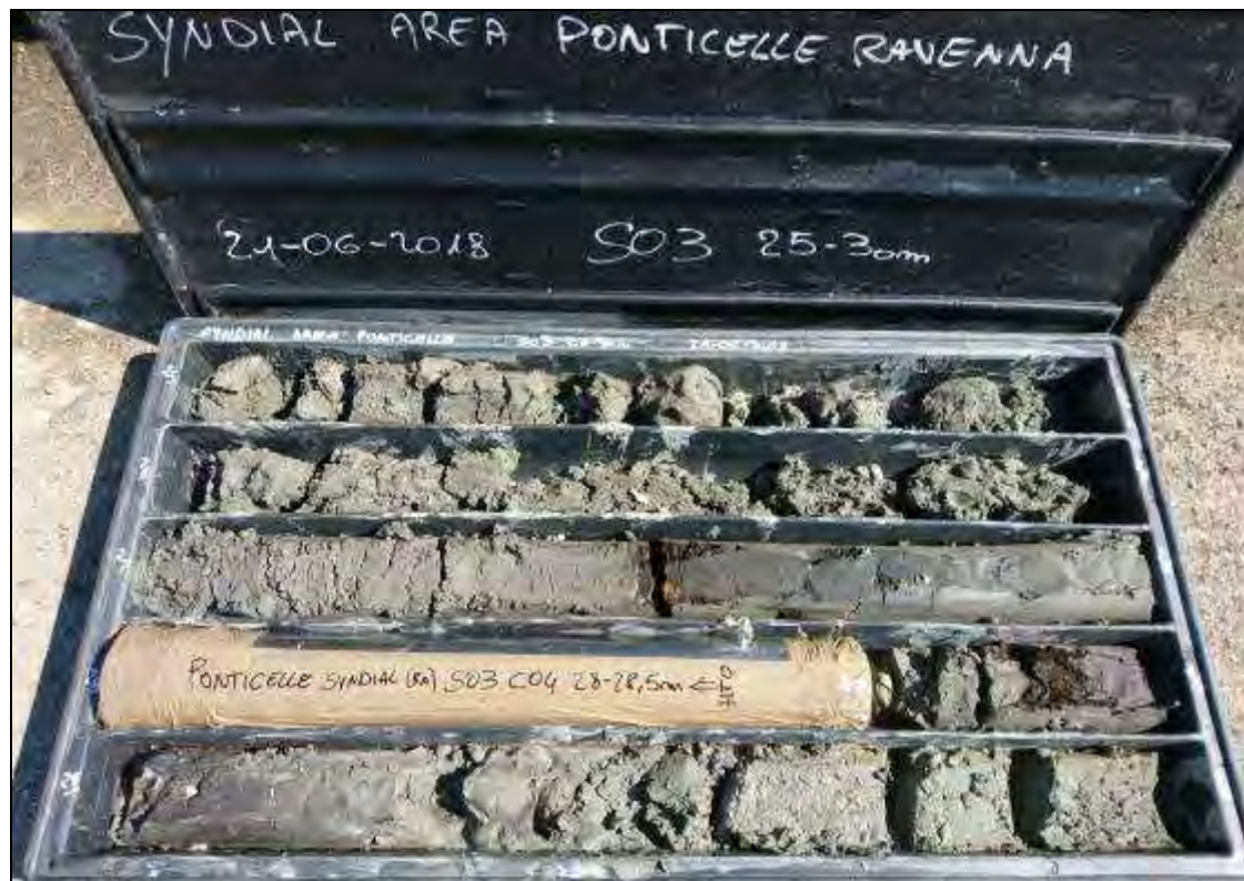
Fig. 24. Carote del tratto compreso tra 25,0m e 30,0m da p.c. del sondaggio S03
