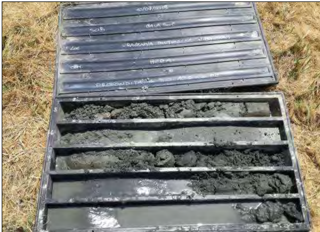
Fig. 36. Carote del tratto compreso tra 5,0m e 10,0m da p.c. del sondaggio S05
