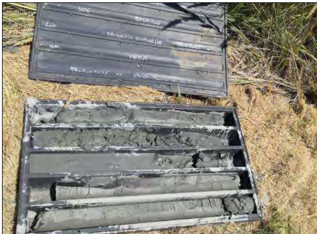
Fig. 48. Carote del tratto compreso tra 25,0m e 30,0m da p.c. del sondaggio S06
