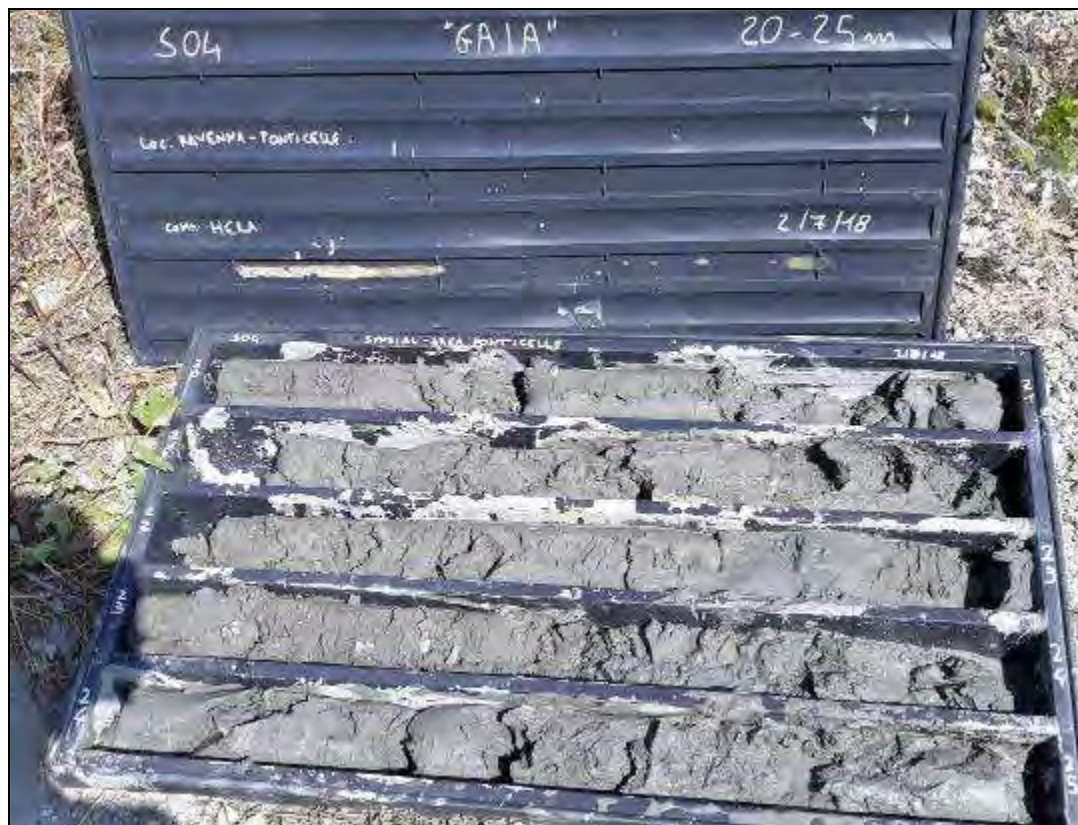
Fig. 31. Carote del tratto compreso tra 20,0m e 25,0m da p.c. del sondaggio S04
