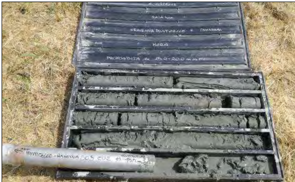
Fig. 38. Carote del tratto compreso tra 15,0m e 20,0m da p.c. del sondaggio S05.
