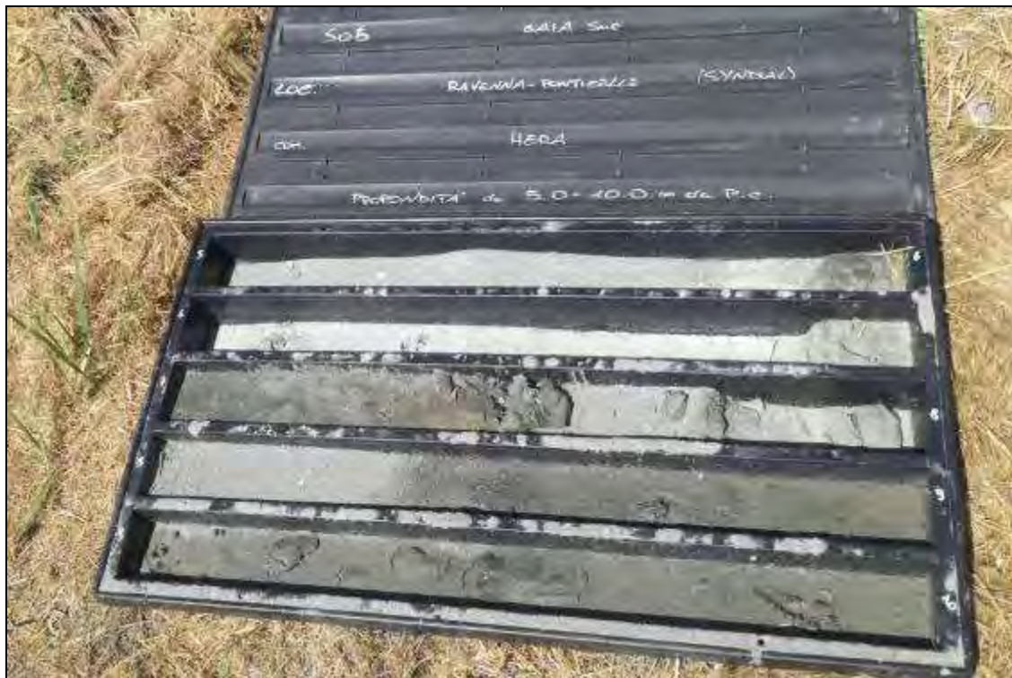
Fig. 44. Carote del tratto compreso tra 5,0m e 10,0m da p.c. del sondaggio S06
