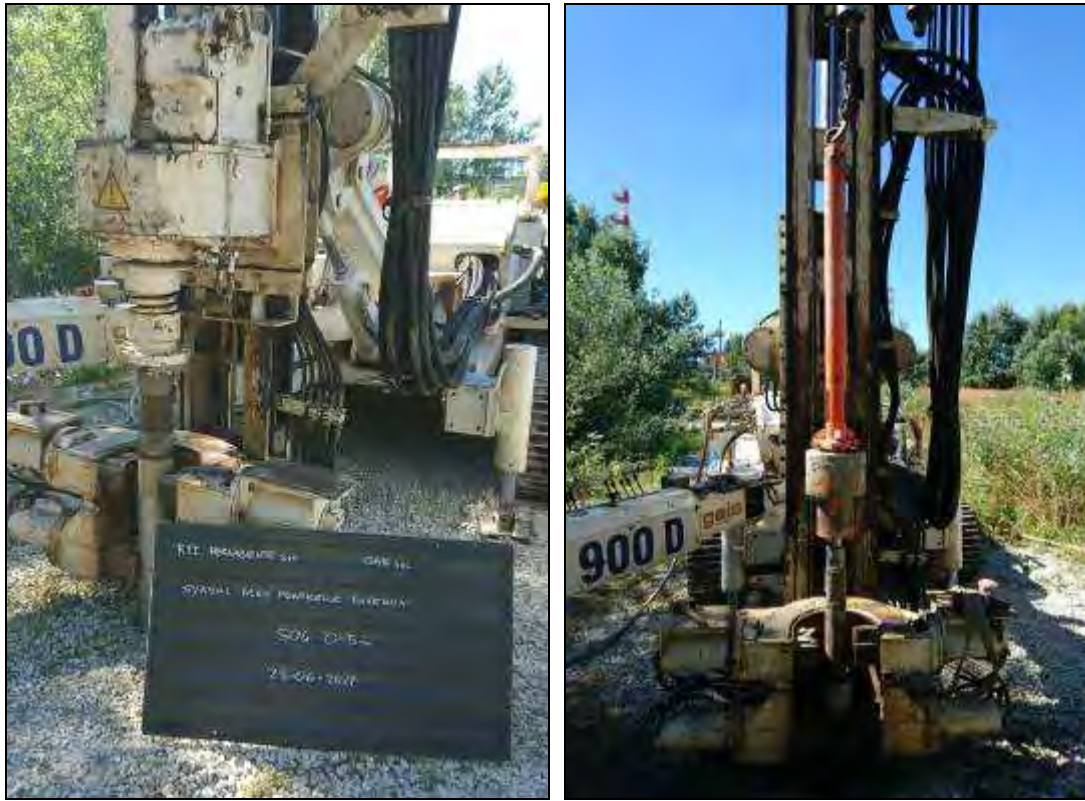
Fig.26. Posizionamento ed esecuzione SPT sondaggio S04 con sonda Gaia.
