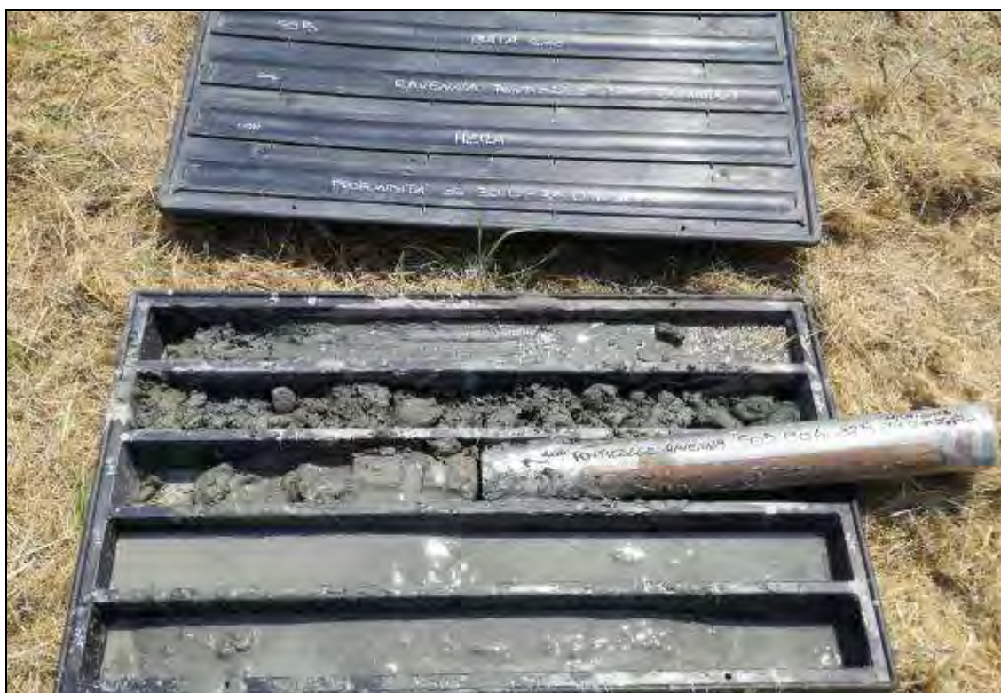
Fig. 41. Carote del tratto compreso tra 30,0m e 35,0m da p.c. del sondaggio S05.
