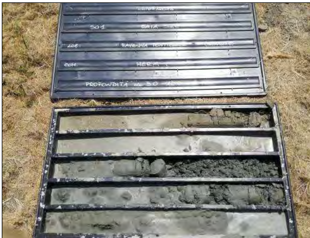
Fig. 4. Carote del tratto tra 5,0m e 10,0m da p.c. del sondaggio S01.
