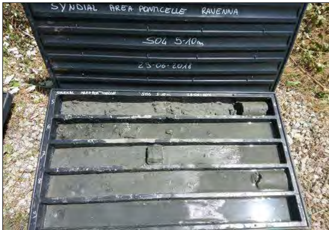
Fig. 28. Carote del tratto compreso tra 5,0m e 10,0m da p.c. del sondaggio S04
