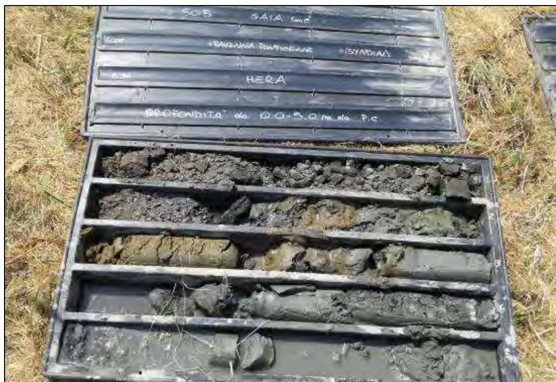
Fig. 35. Carote del tratto compreso tra 0,0m e 5,0m da p.c. del sondaggio S05
