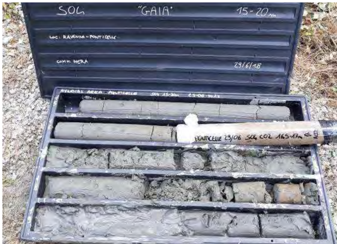
Fig. 30. Carote del tratto compreso tra 15,0m e 20,0m da p.c. del sondaggio S04.
