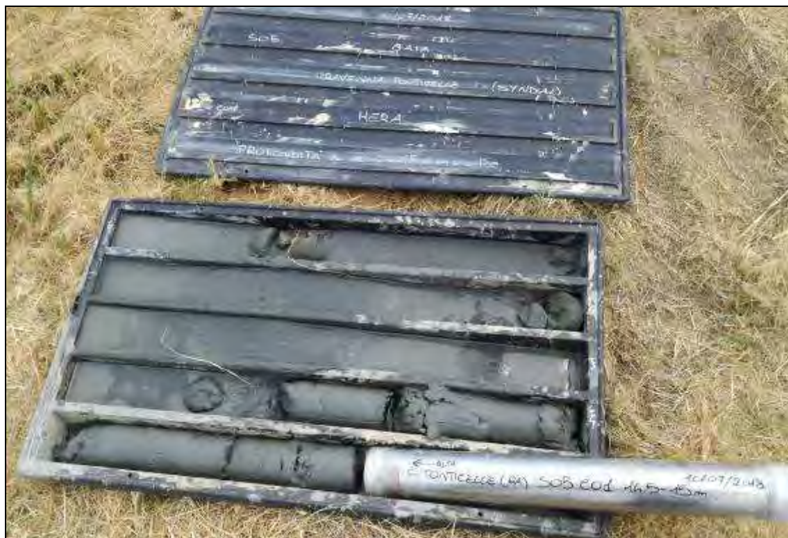
Fig. 37. Carote del tratto compreso tra 10,0m e 15,0m da p.c. del sondaggio S05.
