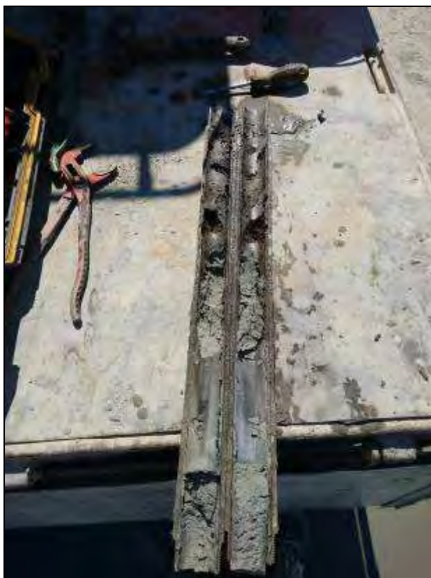
Fig. 17. Campionatore SPT in una delle prove nel sondaggio S02.
