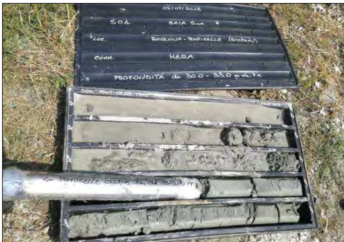
Fig. 33. Carote del tratto compreso tra 30,0m e 35,0m da p.c. del sondaggio S04.
