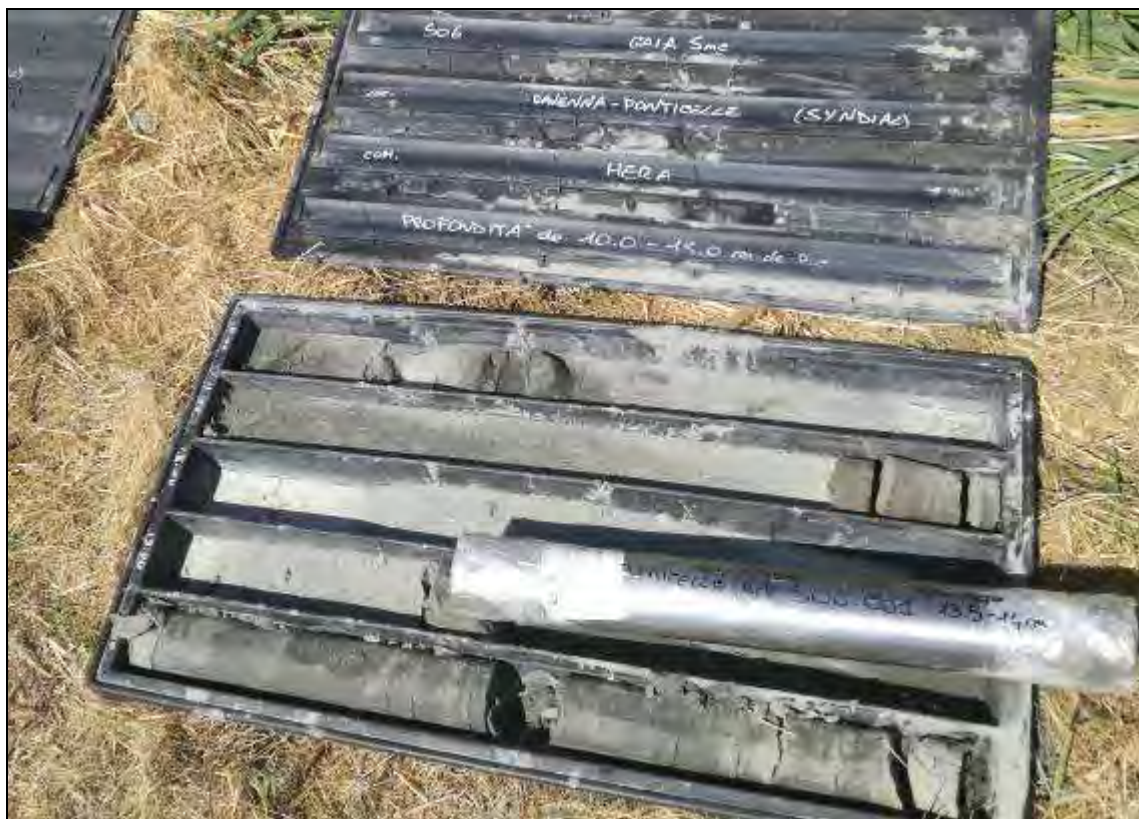
Fig. 45. Carote del tratto compreso tra 10,0m e 15,0m da p.c. del sondaggio S06.
