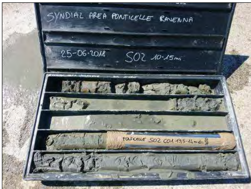
Fig. 12. Carote del tratto compreso tra 10,0m e 15,0m da p.c. del sondaggio S02.
