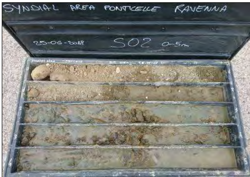
Fig. 10. Carote del tratto compreso tra 0,0m e 0,5m da p.c. del sondaggio BH-02
