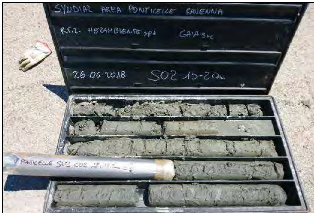
Fig. 13. Carote del tratto compreso tra 15,0m e 20,0m da p.c. del sondaggio S02. .
