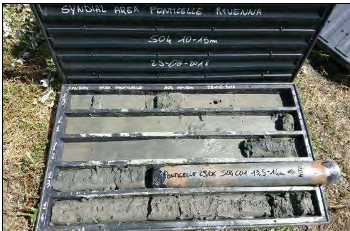
Fig. 29. Carote del tratto compreso tra 10,0m e 15,0m da p.c. del sondaggio S04.
