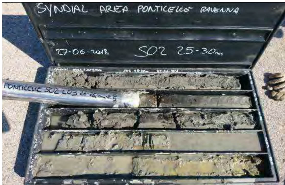
Fig. 15. Carote del tratto compreso tra 25,0m e 30,0m da p.c. del sondaggio S02.
