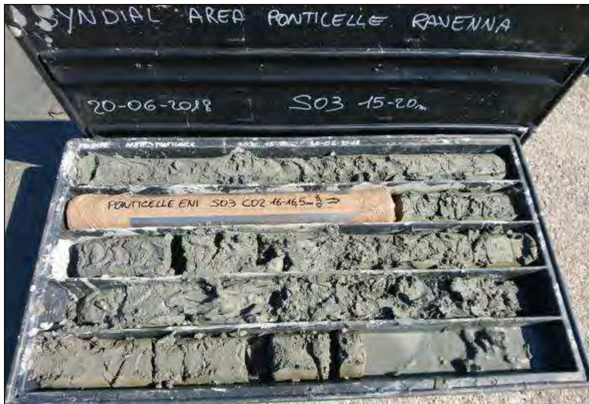
Fig. 22. Carote del tratto compreso tra 15,0m e 20,0m da p.c. del sondaggio S03.
