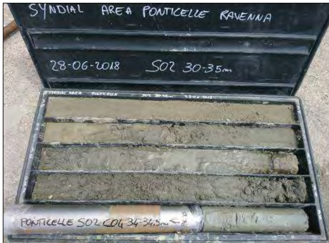
Fig. 16. Carote del tratto compreso tra 30,0m e 35,0m da p.c. del sondaggio S02.
