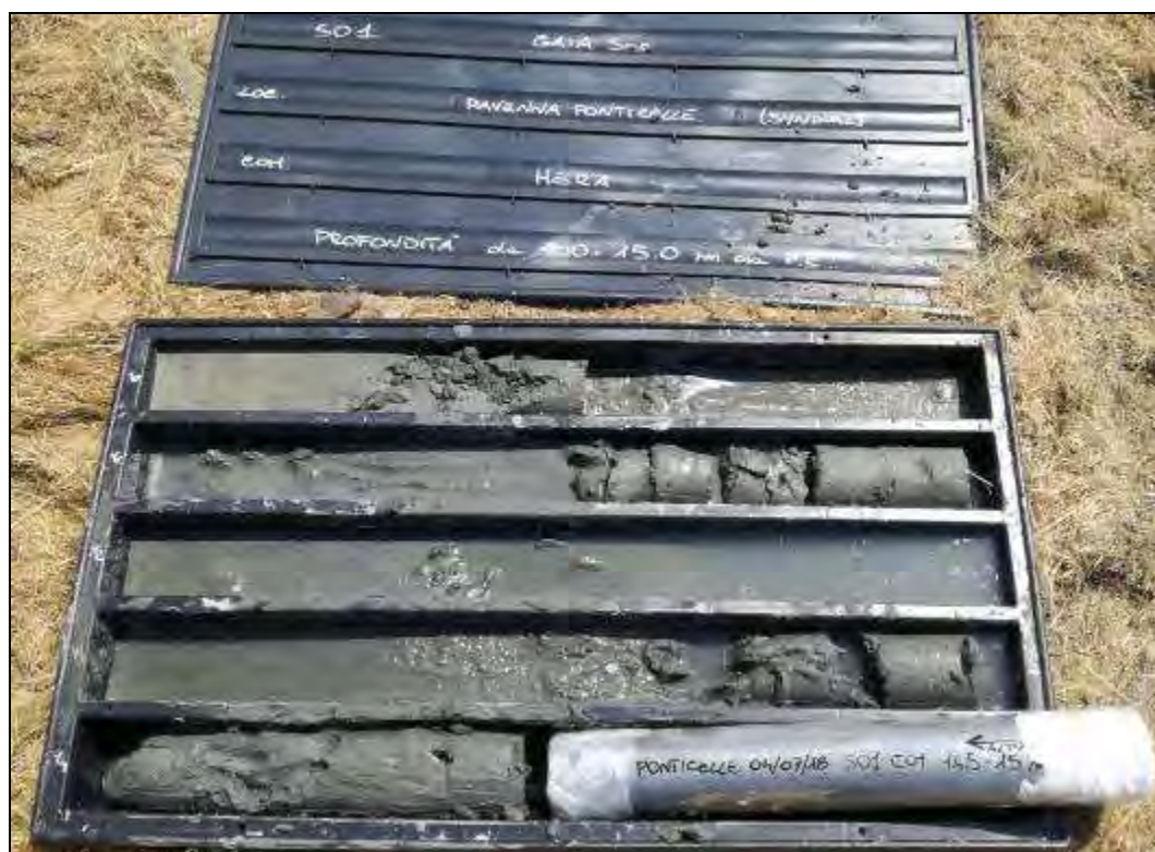
Fig. 5. Carote del tratto tra 10,0m e 15,0m da p.c. del sondaggio S01.
