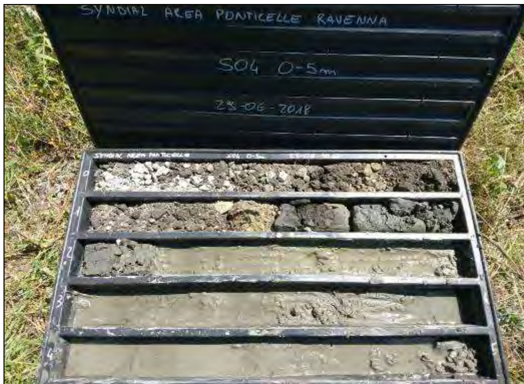
Fig. 27. Carote del tratto compreso tra 0,0m e 5,0m da p.c. del sondaggio S04
