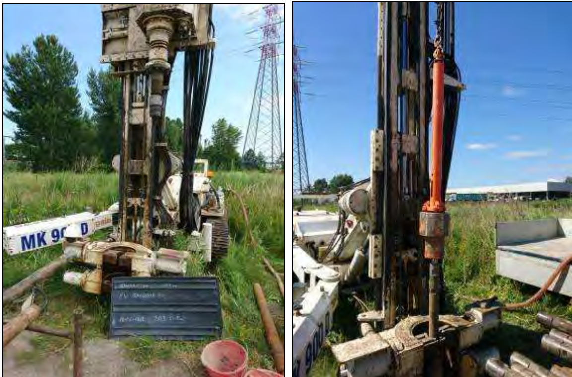
Fig.18. Posizionamento ed esecuzione SPT sondaggio S03 con sonda Gaia.
