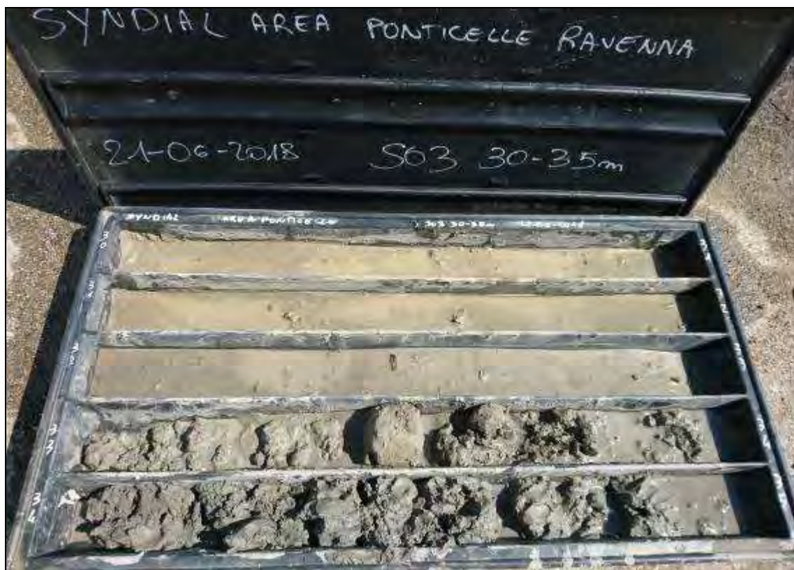
Fig. 25. Carote del tratto compreso tra 30,0m e 35,0m da p.c. del sondaggio S03.
