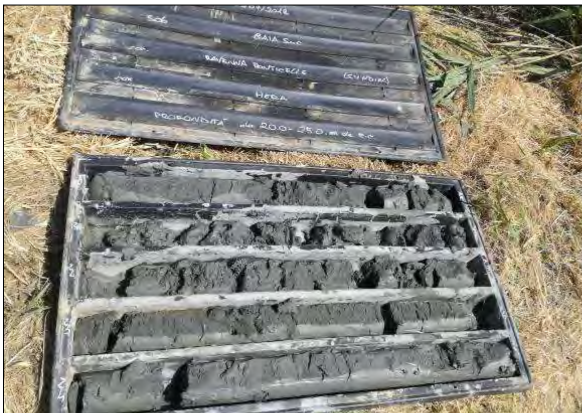
Fig. 47. Carote del tratto compreso tra 20,0m e 25,0m da p.c. del sondaggio S06
