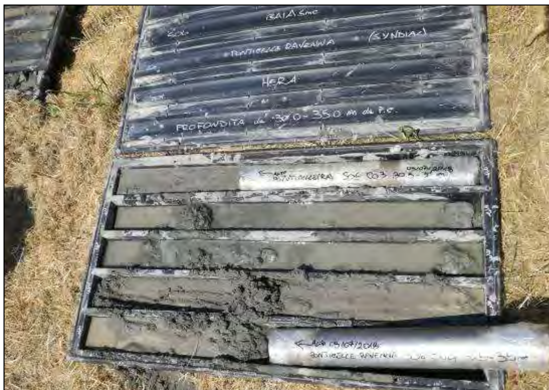
Fig. 49. Carote del tratto compreso tra 30,0m e 35,0m da p.c. del sondaggio S06.
