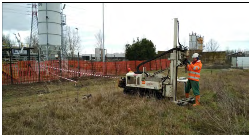
Fig. 34.. Esecuzione della prova CPTU-06, piazzamento della sonda (Geoprobe Gaia) e delimitazione dell'area con nastro B/R.
