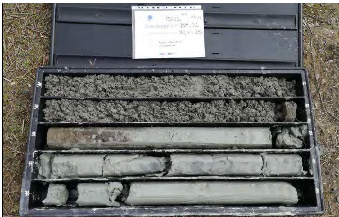
Fig. 8. Carote del tratto compreso tra 30,0m e 35,0m da p.c. del sondaggio BH-01.
