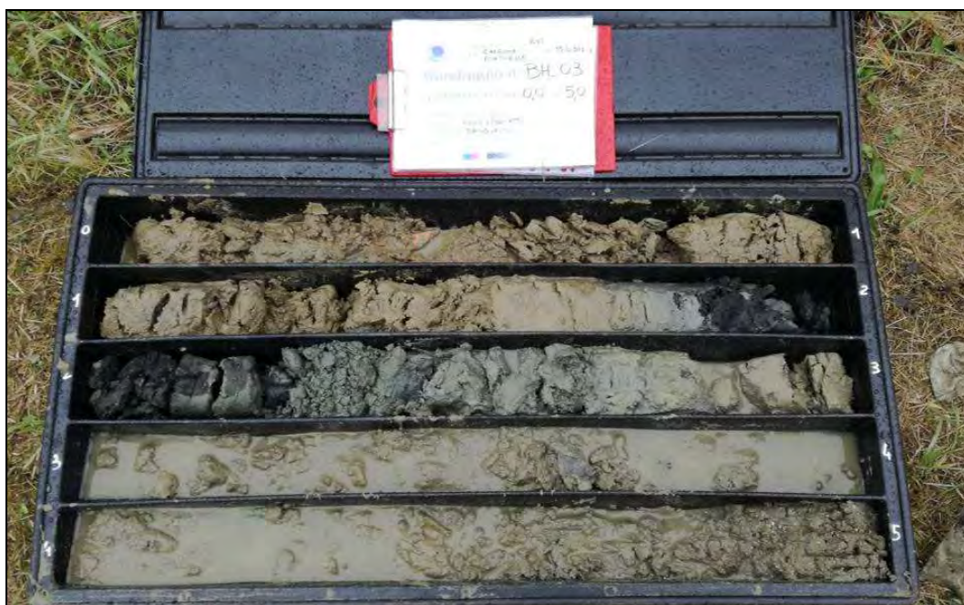
Fig. 21. Carote del tratto compreso tra 0,0m e 5,0m da p.c. del sondaggio BH-03
