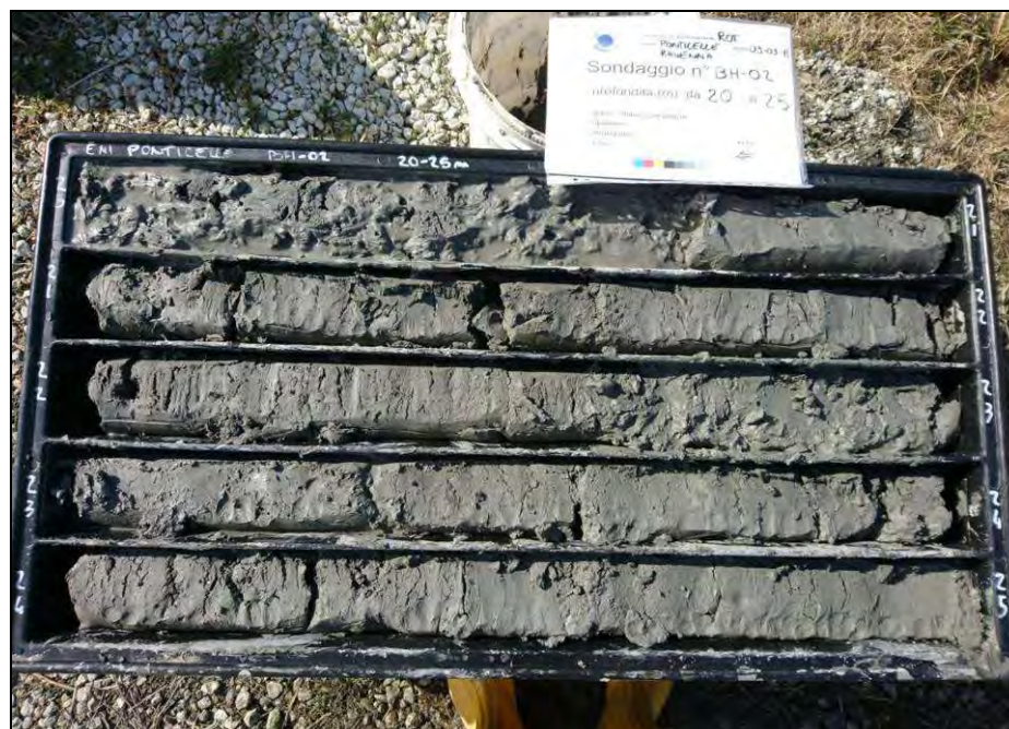
Fig. 15. Carote del tratto compreso tra 20,0m e 25,0m da p.c. del sondaggio BH-02.
