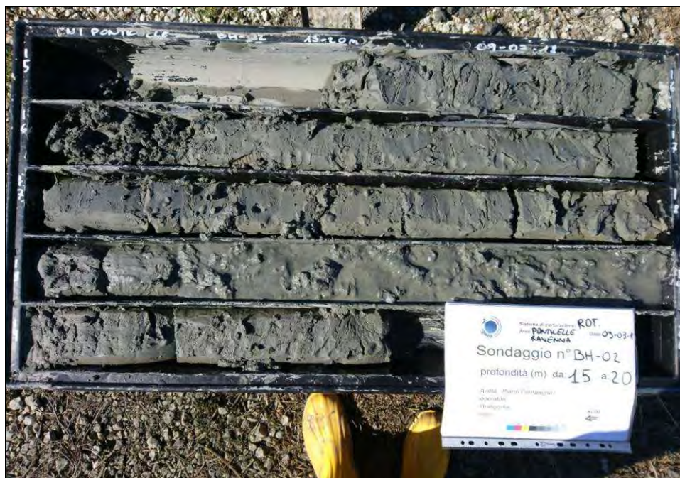
Fig. 14. Carote del tratto compreso tra 15,0m e 20,0m da p.c. del sondaggio BH-02. Vuoto tra 15,0m - 15,5m e 19,5m-20,0m per prelievo campioni indisturbati.
