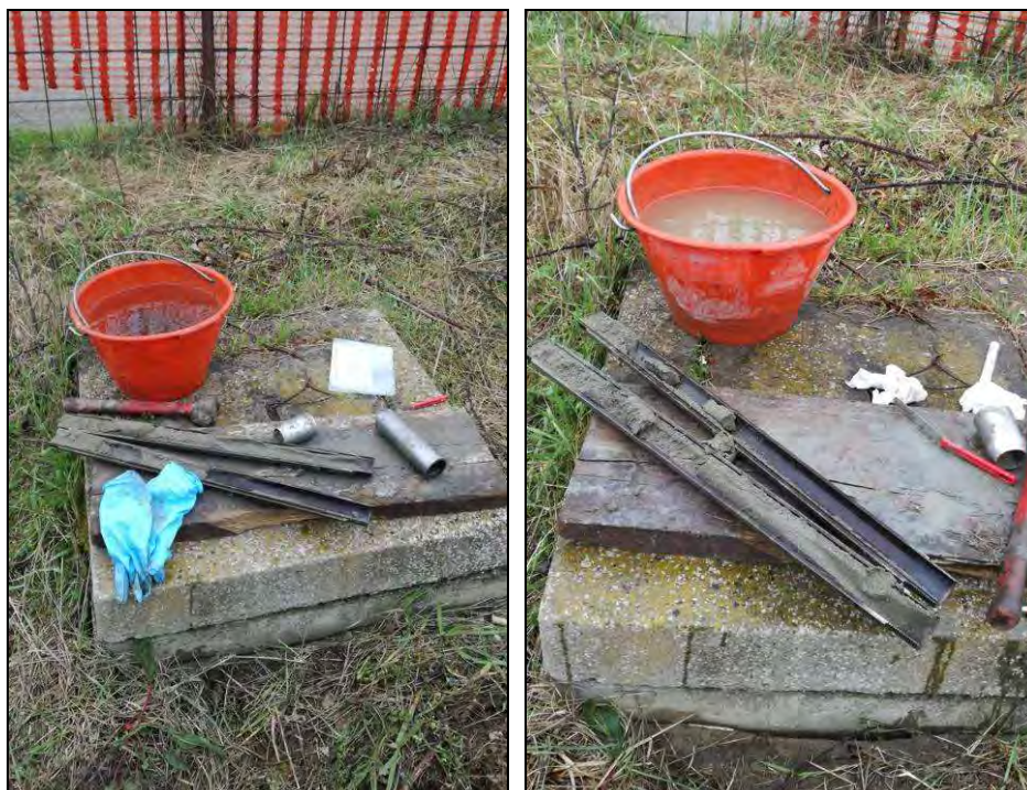
Fig. 29. Apertura del campionatore utilizzato per le SPT effettuate all'interno dei sondaggi.
