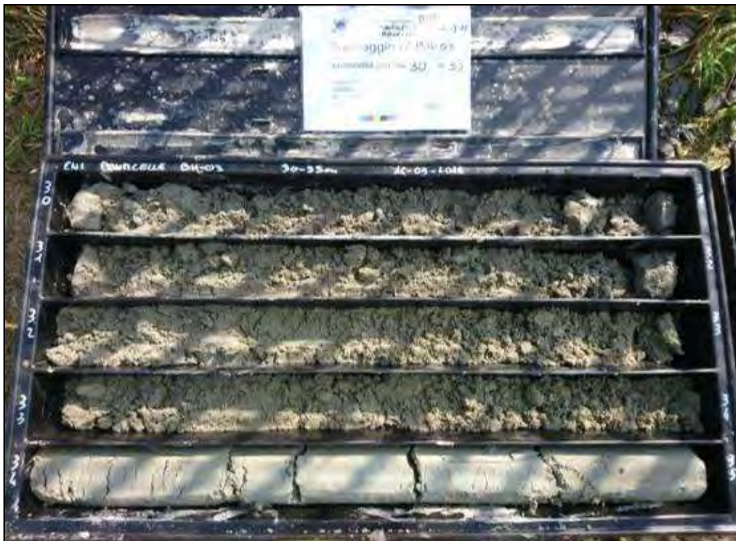
Fig. 27. Carote del tratto compreso tra 30,0m e 35,0m da p.c. del sondaggio BH-03.
