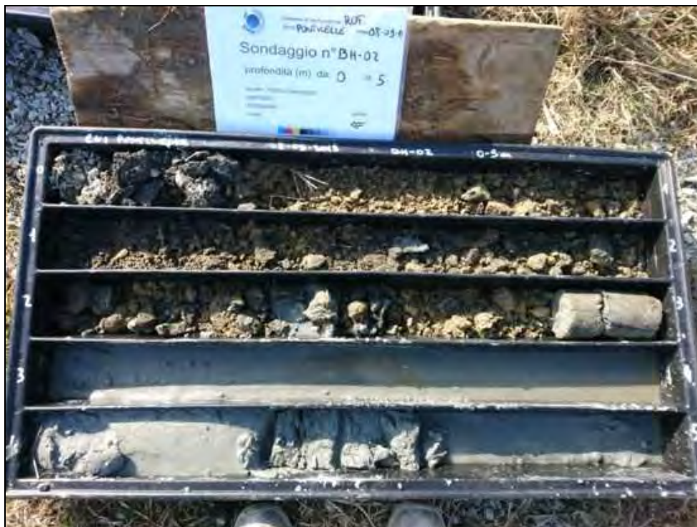
Fig. 11. Carote del tratto compreso tra 0,0m e 0,5m da p.c. del sondaggio BH-02
