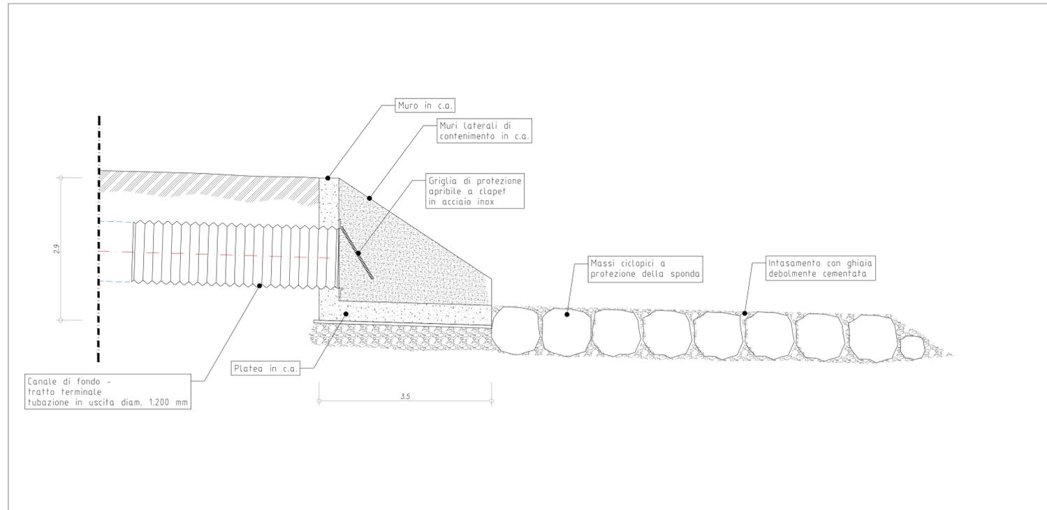
OPERA DI RESTITUZIONE SUL RIO MORSANO - PIANTA
