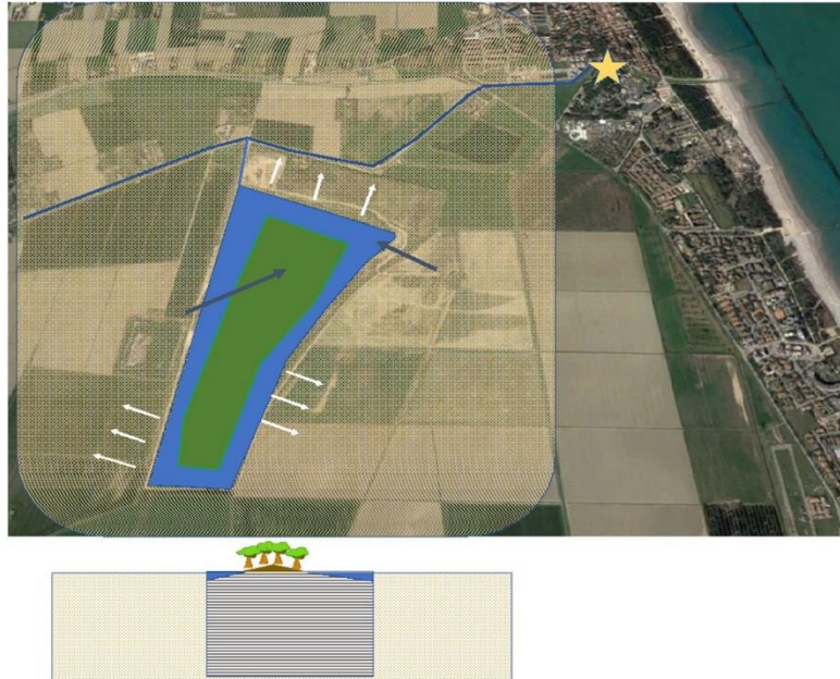
Figura 4 Possibile sistemazione con tombamento per il Polo Morina. Rappresentazione non esaustiva della bassura perimetrale allagabile/vasca di laminazione capace di infiltrare acqua nel confinante acquifero freatico. Altura centrale con rimboschimento. Nella parte sottostante rappresentazione non esaustiva della sezione A-A'.
