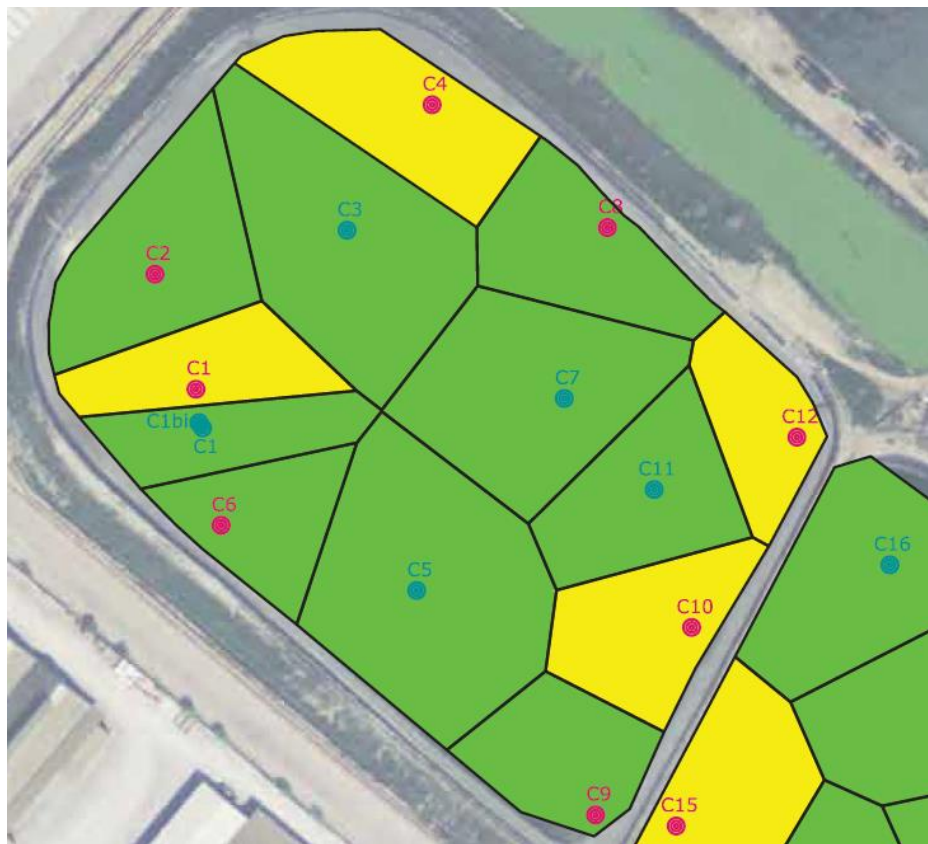
Figura 12 – Ubicazione punti di indagine 2013 (in rosso) e 2017 (in azzurro). I colori verdi e giallo si riferiscono alla conformità del materiale alle CSC di Colonna A (colore verde) o di Colonna B (colore giallo). I dati sono riferiti allo strato a 4-5 m dal p.c. al momento della caratterizzazione, ossia allo strato che costituirà il p.c. al momento dell'avvio del cantiere del progetto ora in esame.
