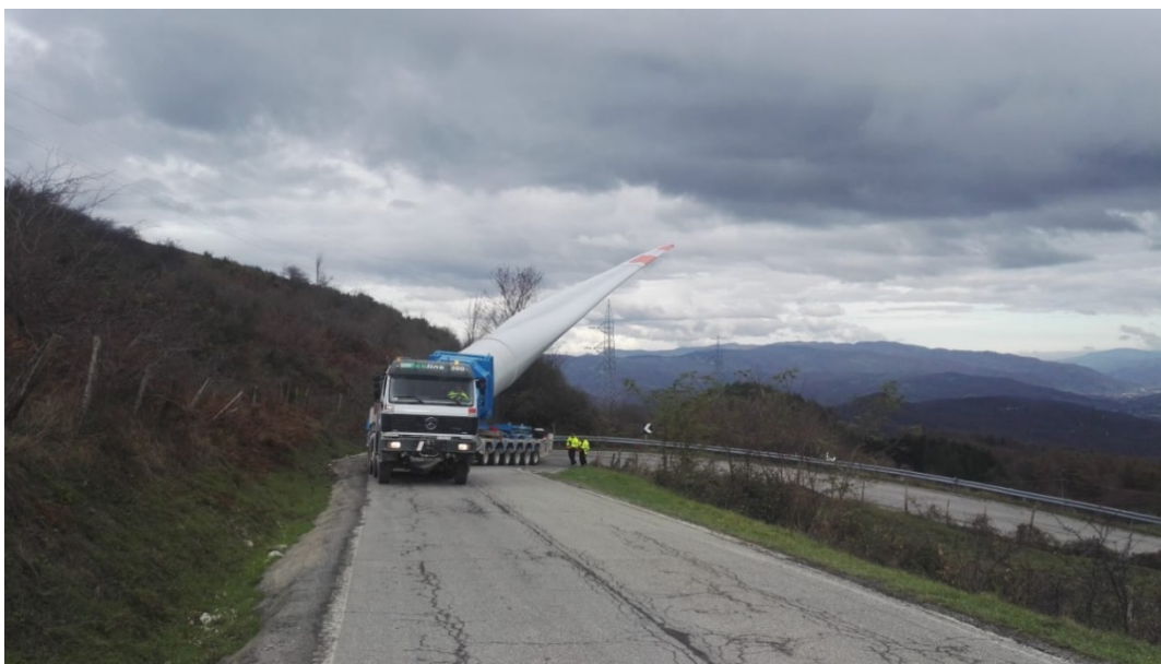
Figura 10: mezzo trasporto eccezionale speciale pala (blade lifter)
