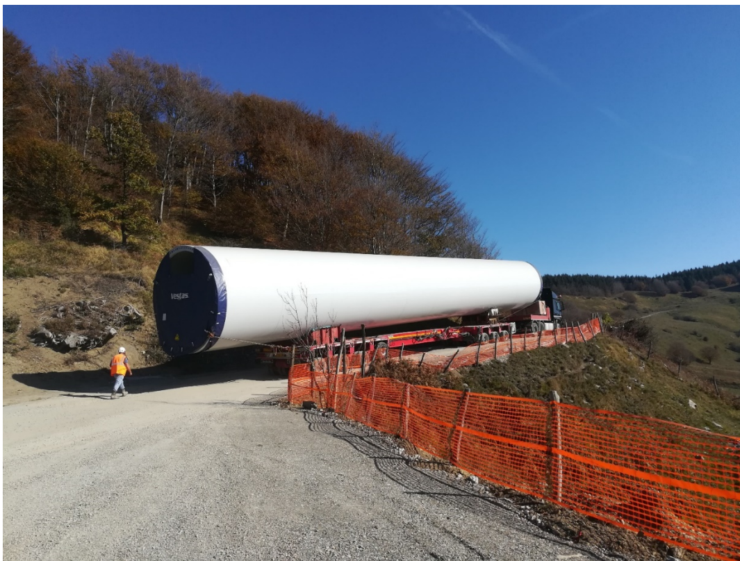
Figura 11: mezzo trasporto eccezionale speciale tronco di torre (semovente)
