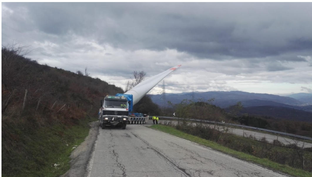
Fig. 10: mezzo trasporto eccezionale speciale pala (blade lifter)
