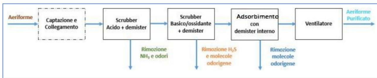
Figura 4-2: schema processo abbattimento emissioni odorigene
