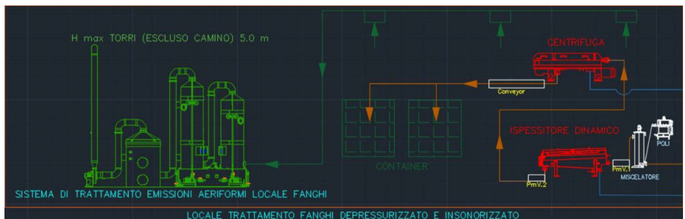
Figura 4-4: schema trattamento odori linea fanghi
