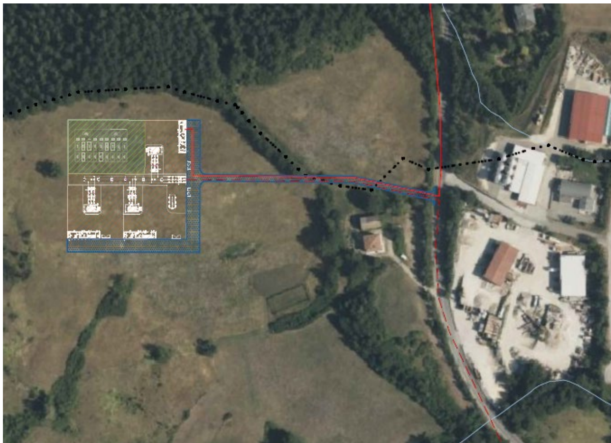
Sottostazione Elettrica 132/30 kV (retino arancione) e sistema di accumulo (retino verde) in agro di Castiglione dei Pepoli (BO)
