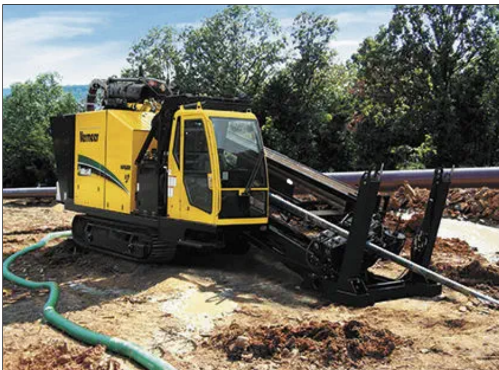
Figura 2. Esempio di macchina perforatrice per TOC
