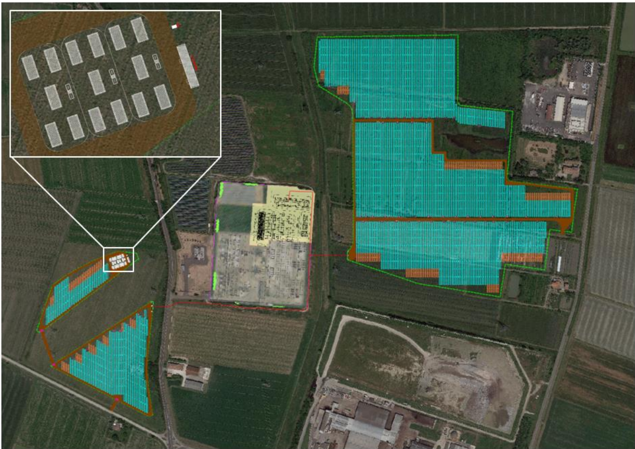
Figura 2. Layout di impianto su immagine aerea. Rappresentati rispettivamente in azzurro i moduli fotovoltaici, in verde la recinzione perimetrale, in marrone (polilinea continua) la viabilità interna, in rosso (polilinea tratteggiata) il cavidotto di connessione AT 36 kV. Sono, infine, indicati i locali tecnici di progetto: n. 2 cabine di smistamento, n. 6 cabine di trasformazione, n. 3 isole BESS.
