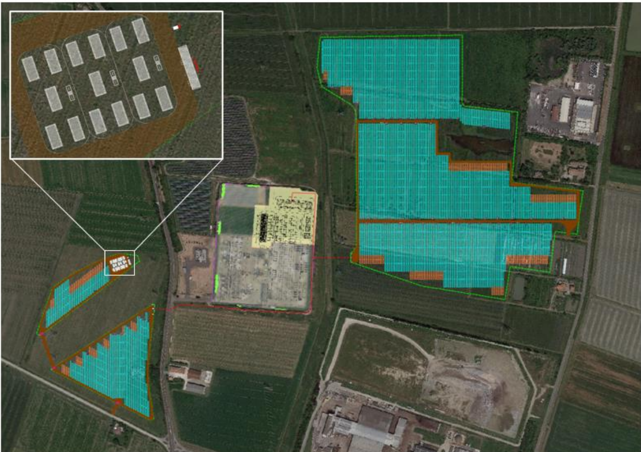
Figura 1. Layout di impianto su immagine aerea. Rappresentati rispettivamente in azzurro i moduli fotovoltaici, in verde la recinzione perimetrale, in marrone (polilinea continua) la viabilità interna, in rosso (polilinea tratteggiata) il cavidotto di connessione AT 36 kV. Sono, infine, indicati i locali tecnici di progetto: n. 2 cabine di smistamento, n. 6 cabine di trasformazione, n. 3 isole BESS.
