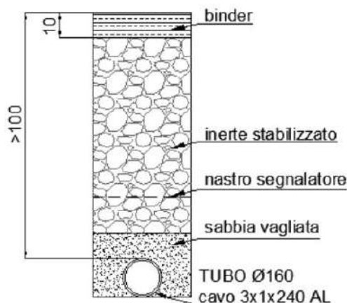
Figura 4: Esempio di attraversamento con semplice scavo
