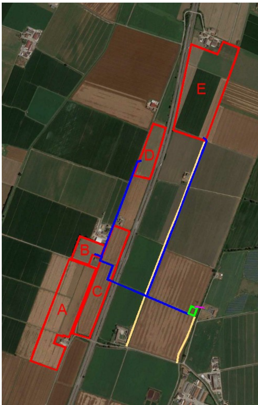
Figura 2.1.3: Inquadramento su foto aerea dell'area di progetto (fonte: Google Earth ®). In rosso sono indicate le aree in disponibilità per la realizzazione dell'impianto fotovoltaico, in blu la linea interrata di connessione elettrica MT, in verde l'area della sottostazione elettrica, in magenta la linea di connessione AT e in giallo le servitù di accesso.
