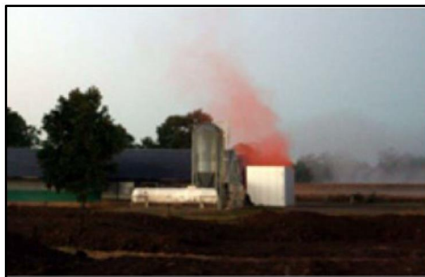
Test effettuato con tracciante fumogeno (IOWA University)
