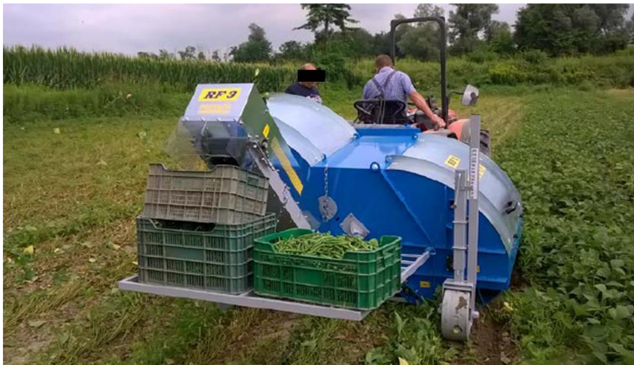
Figura 6-16-Macchina raccoglitrice per fagiolino (non presente in azienda ma compatibile con l'interfila dell'impianto agrivoltaico)
